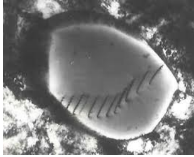
Figure 1.2: Micrographie obtenue en microscopie électronique en transmission montrant la présence de dislocations dans un acier inoxydable ( https://fr.wikipedia.org/wiki/Dislocation )
