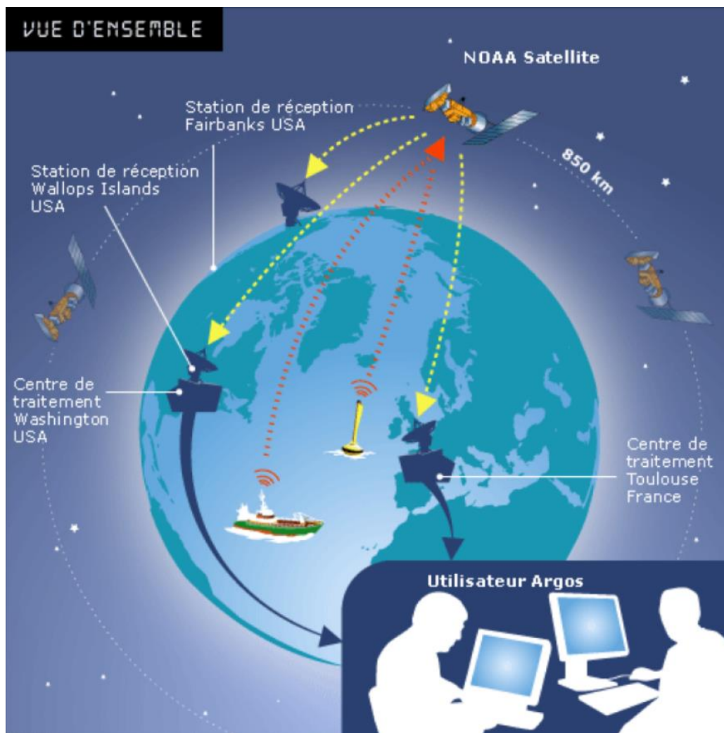
Figure 2-3 : Schéma explicatif du principe de fonctionnement du système Argos. Cette image est issue du site argos-mission.cnes.fr .
