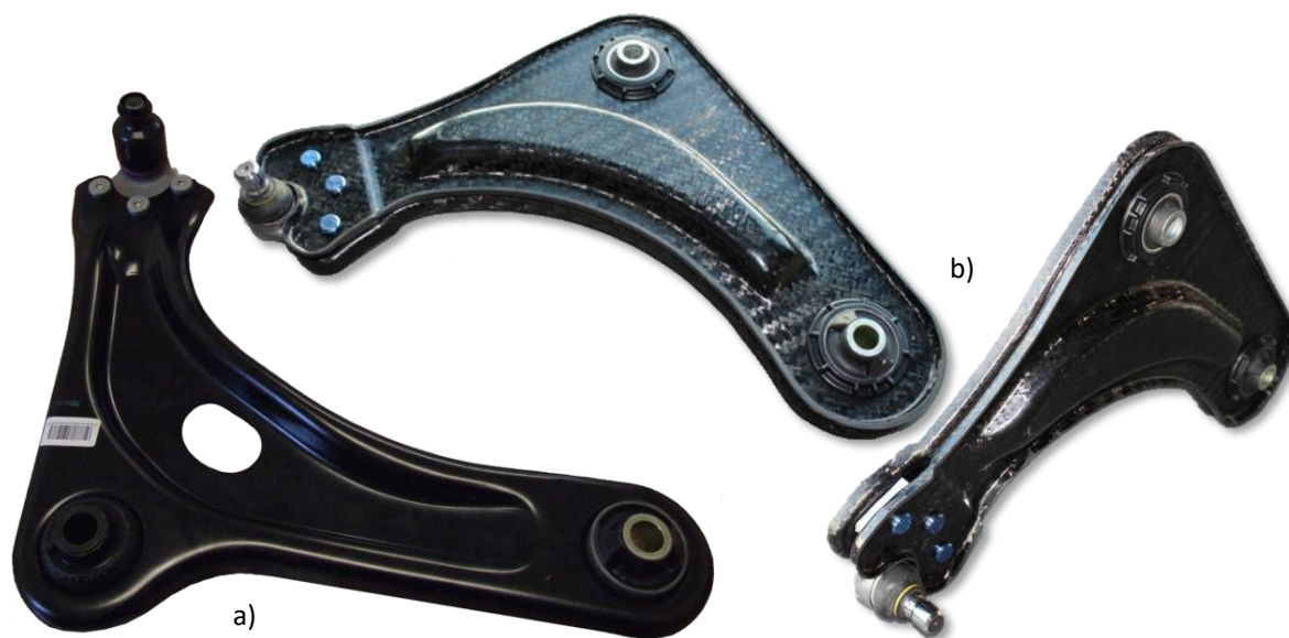
FIGURE 4.1 – Triangle de suspension. a) Solution métallique de référence. b) Solution composite thermoplastique (JEC 2013).
