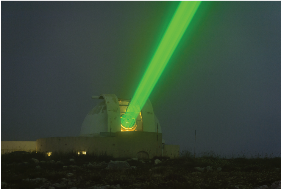
FIGURE 1.3 – Le télescope utilisé par l’Observatoire de la Côte d’Azur pour l’expérience de télémétrie Laser-Lune du site de Calern.
