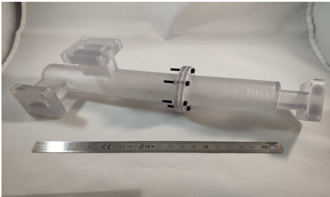
Figure II-33 : Photographie de la structure imprimée en 2 blocs assemblés
