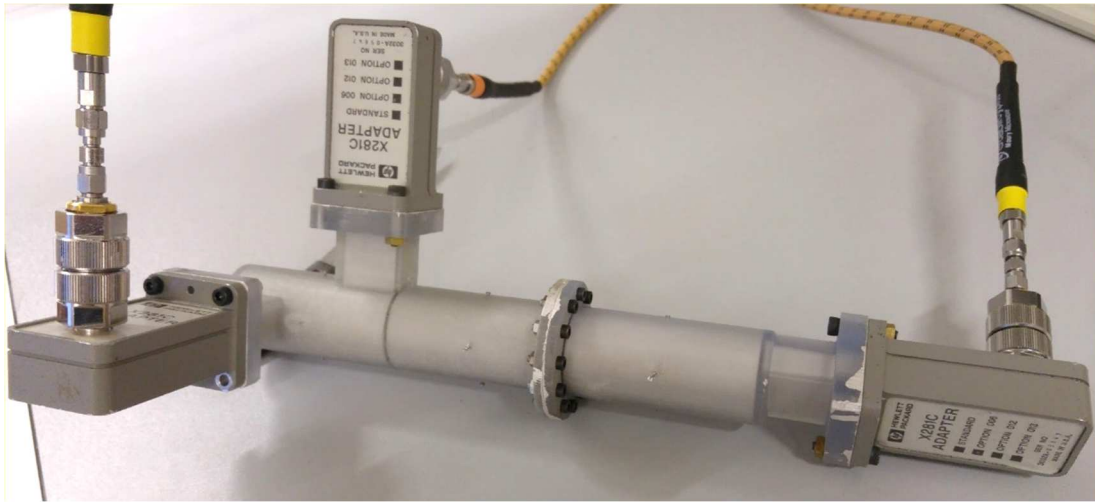
Figure II-34 : Structure de filtrage après métallisation et connectée pour caractérisation
