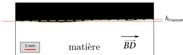
FIGURE 4.20 – Mesure de la hauteur de raccordement
