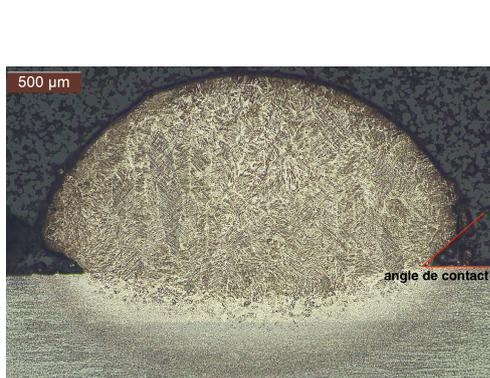
(a) Observation au microscope optique de la coupe d'un cordon avec un angle de contact aigu
