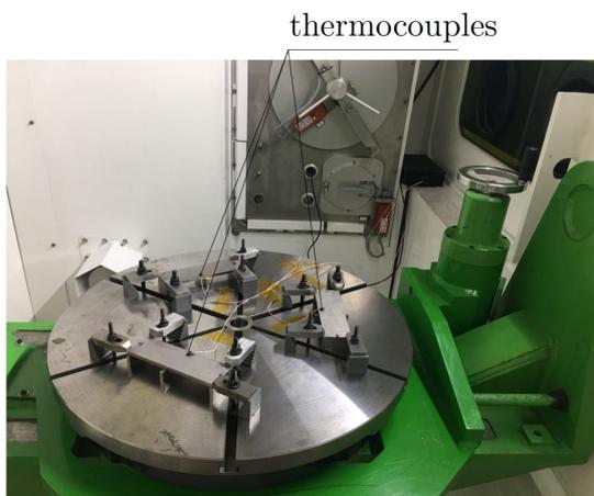
(a) Montage des thermocouples sur les substrats
