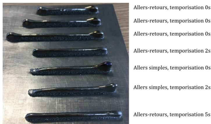
FIGURE 2.12 – Essais de stratégies de fabrication des murs
