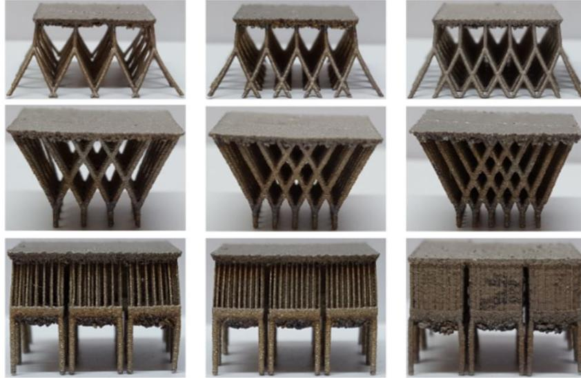
FIGURE 1.14 – Essais de fabrication de plaques fines en 316L avec différentes configurations de supports en SLM [34]
