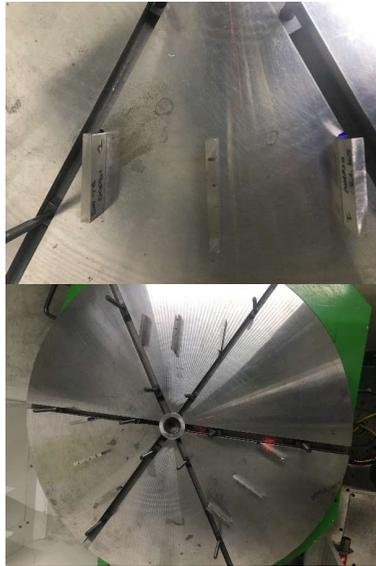
**B5.** Tracer sur le dessus des substrats les repères suivants : un marquage à 5mm du bord, au centre sur la largeur, pour indiquer le point de départ de la fabrication, une flèche pour indiquer le sens vers le centre du plateau (cf. photographie ci-contre) puis les placer sur les contre-appuis positionnés. Le bord (côté centre plateau) du substrat doit se trouver au niveau du repère 13cm.
