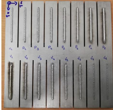
FIGURE 2.4 – Photographie d'un substrat entaillé et de seize cordons fabriqués
