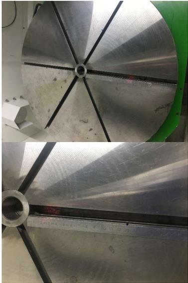
**B3.** Visser les écrous en T sur les goujons correspondants (sur la partie vis la plus courte). Insérer 2 montages écrous-goujons par rainure du plateau (un positionné vers le centre et l'autre vers l'extérieur).
