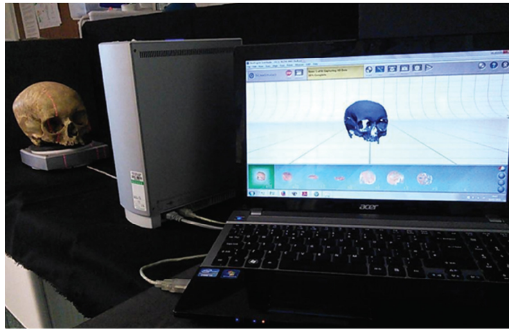
Figure 4.1 Exemple d'utilisation du scanner surfacique NextEngine®(modifié d'après White, 2015). Le crâne est déposé sur une plateforme tournante, permettant ainsi aux rayons laser de scanner la surface avec un angle de 360 degrés
