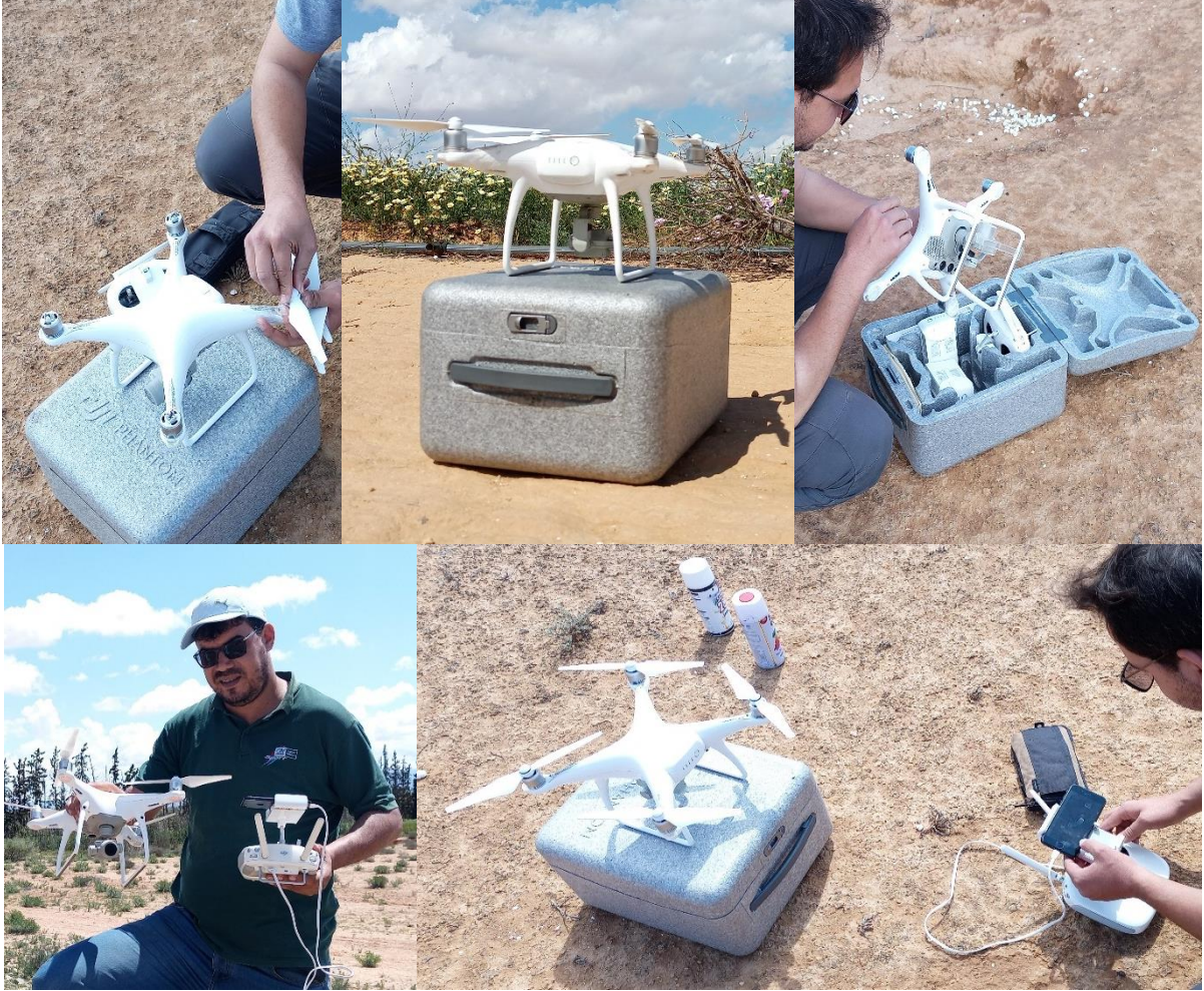
الصورة رقم 45: إعداد جهاز DJI Phantom 4 Pro لطيران.
