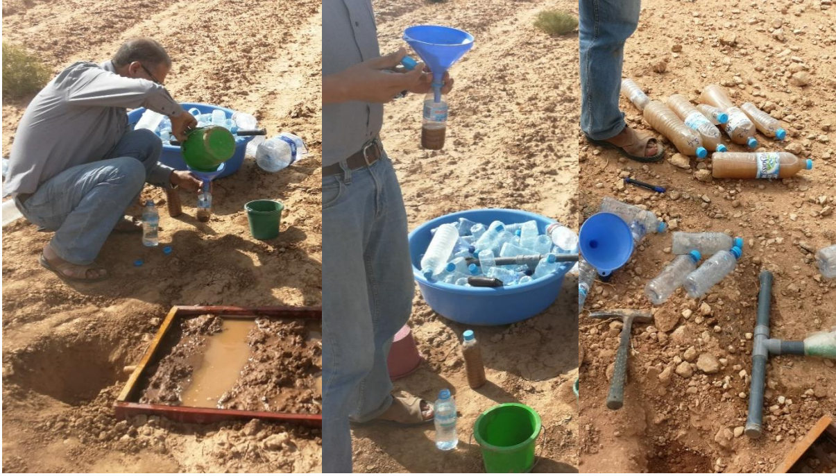
الصورة رقم 33: جمع الماء الجاري (الحمولة الصلبة)
