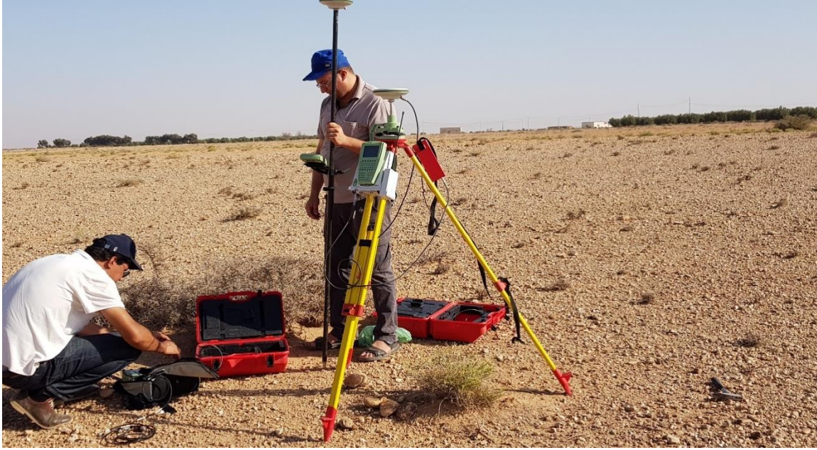
الصورة رقم 41: جمع أجزاء الجهاز الثابت والمتحرك، وتهيئته لعملية القياس
