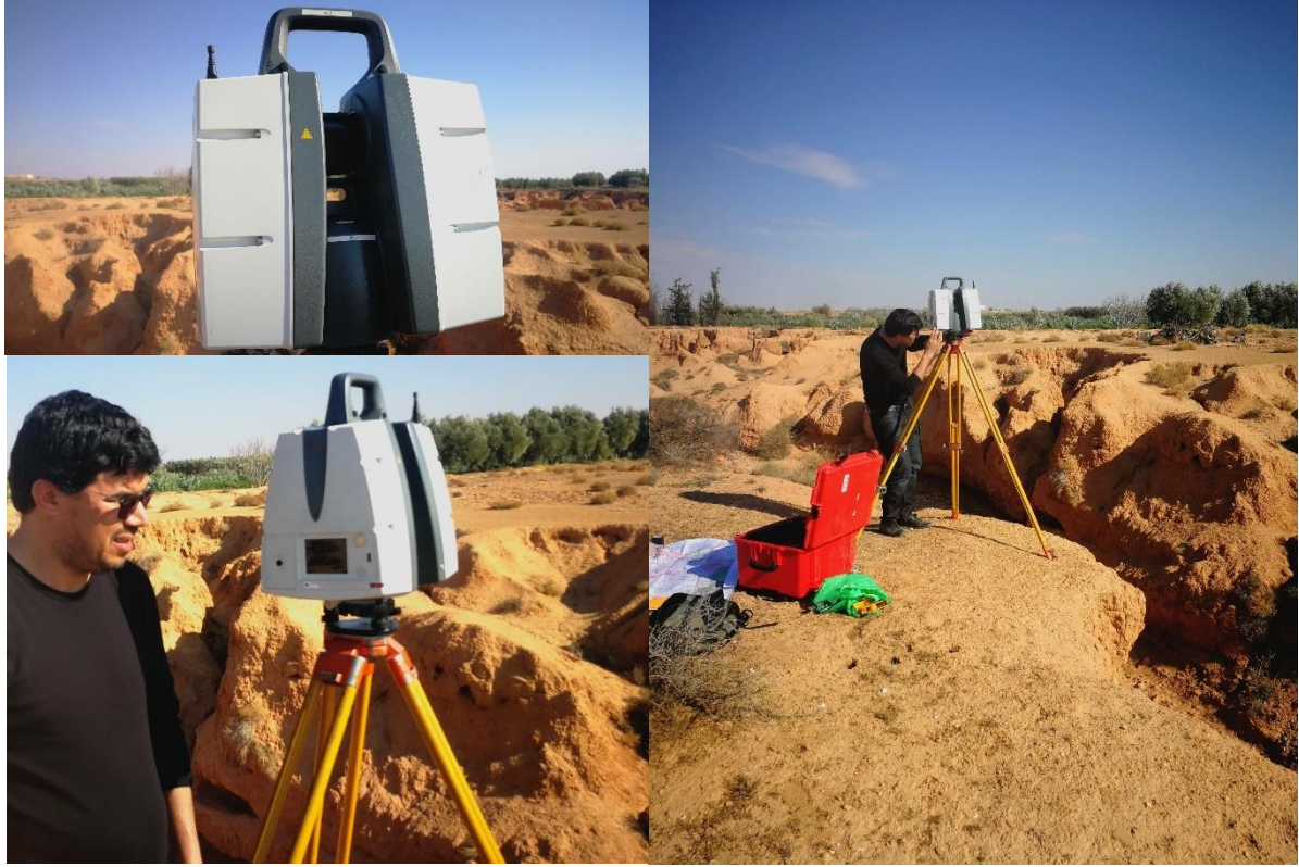
الصورة رقم 43: الماسح الأرضي الليزري من نوع Leica Scan P40، ومكوناته
