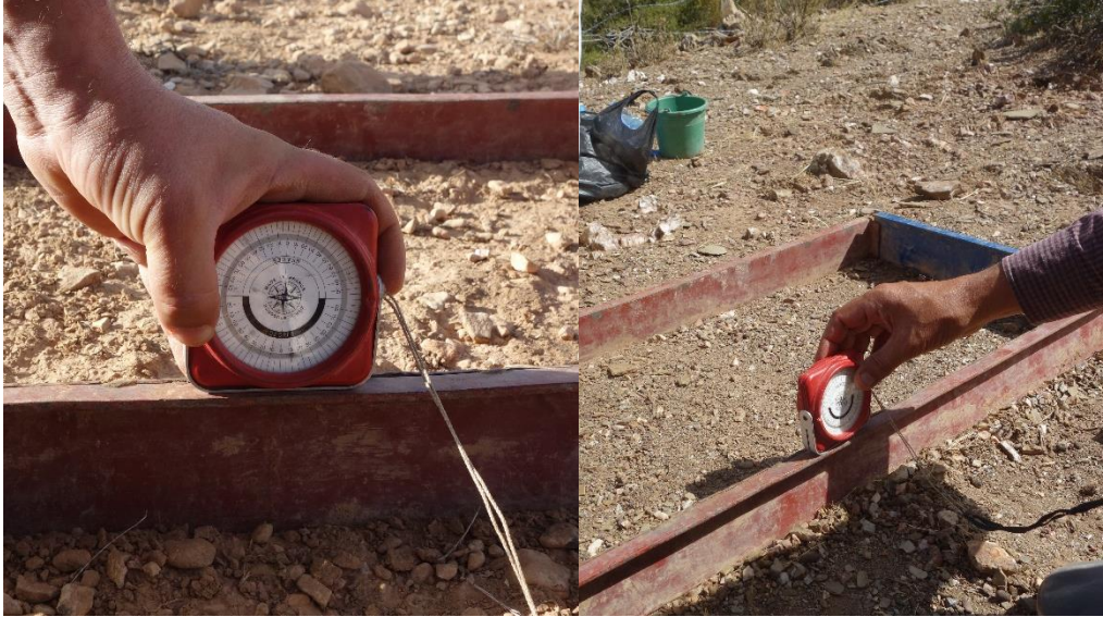
الصورة رقم 26: تحديد اتجاه المشارة، وقياس الإنحدار
