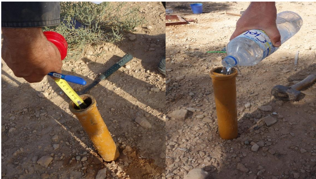
الصورة رقم 28: قياس النفاذية
