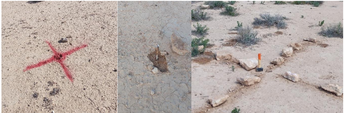
الصورة رقم 46: نقط مرجعية لرصدها بالطائرة بدون طيار بحوضي اتلاغ والعابد.
