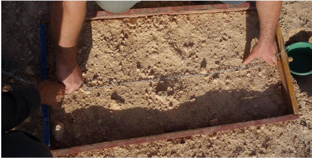
الصورة رقم 27: قياس خشونة السطح
