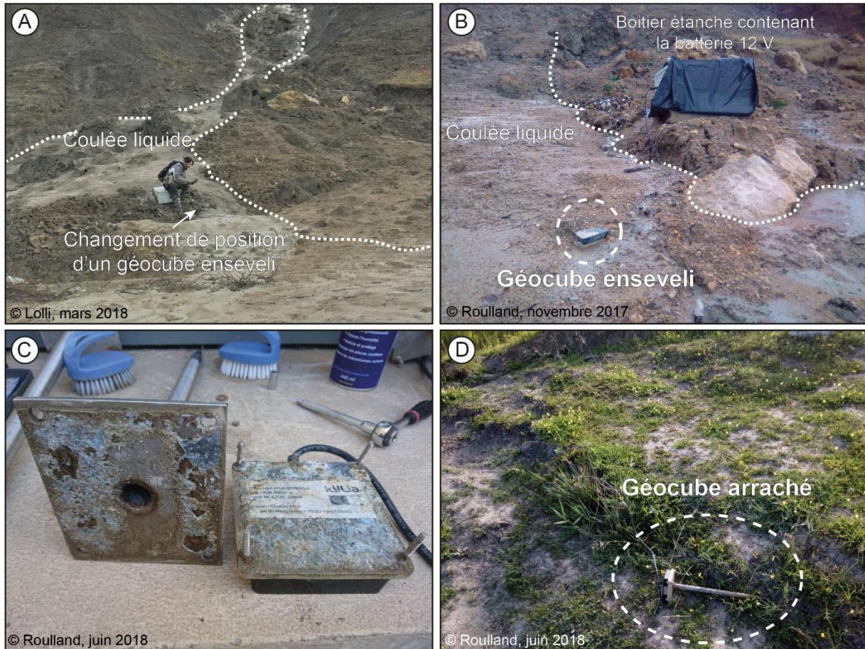
Figure 7.23 : Illustration de certaines problématiques inhérentes au suivi du site actif DYNALIT des falaises des Vaches Noires ; A) Changement de position d'un géocube recouvert par la coulée n°3 liquide (photo : Lolli, mars 2018) ; B) Illustration d'un géocube enseveli par la coulée n°3 liquide ; C) Corrosion visible sur la surface du piquet en acier et sur la plaque métallique d'un géocube ; D) Géocube arraché et déconnecté de son alimentation durant le début de la saison touristique
