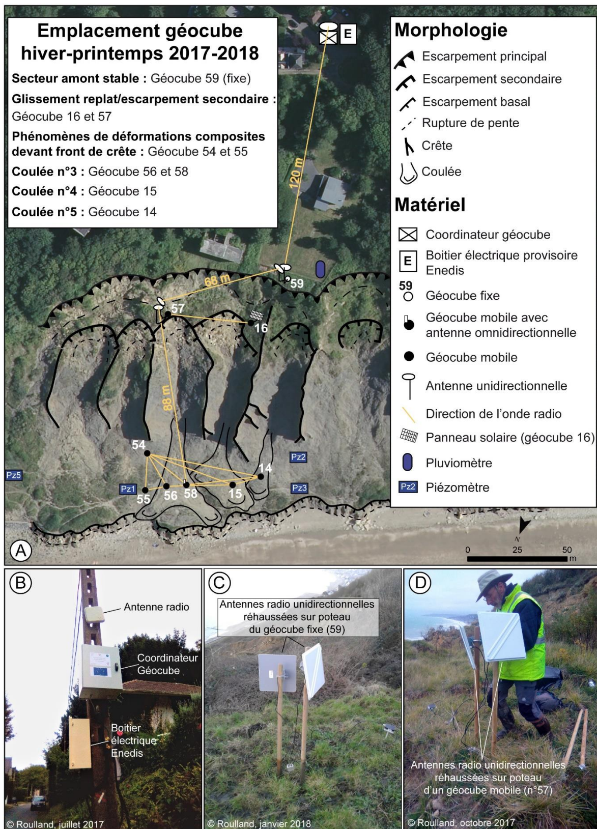
Figure 7.2 : Présentation de l'implantation du dispositif géocube sur le site DYNALIT pour l'année 2017 - 2018 ; A) Plan d'implantation et de répartition du dispositif géocube ; B) Illustration du coordinateur, de l'antenne radio et du boîtier électrique ENEDIS implantés sur poteau électrique ; C) Illustration des antennes unidirectionnelles implantées en haut de versant pour le géocube 59 fixe ; D) Illustration des antennes unidirectionnelles implantées sur le replat sous-jacent à la corniche calcaire oxfordienne d'un géocube 57 mobile
