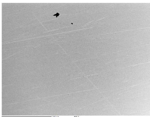
Figure AC.3. Cartographie de rayons X faite à la microsonde de Castaing de l'alliage Nb_{0,05}Zr_{0,95} en mode rétrodiffusé.
