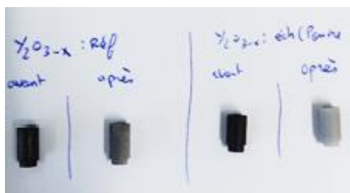
Figure 4-6. Creusets Y_2O_{3-x} avant (à gauche) et après (à droite) l'analyse calorimétrique.
