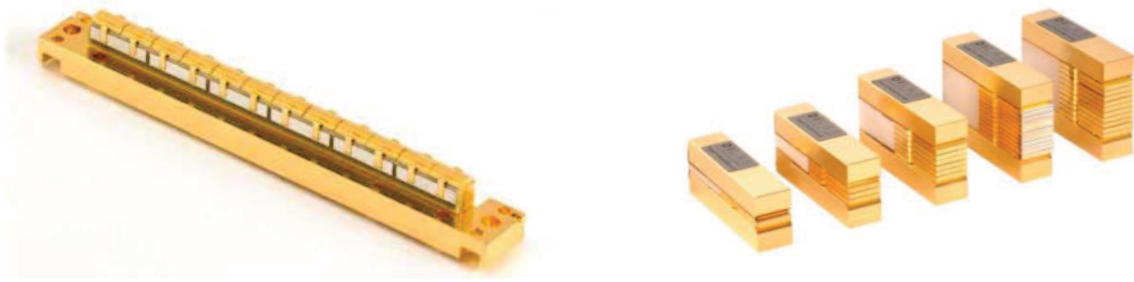
Figure 23: Photographie de dispositifs de diodes lasers à empilement horizontal (à gauche, DILAS). Photographie de plusieurs dispositifs de barrettes de diodes laser variant de gauche à droite d'une barrette à dix barrettes (à droite, Cutting Edge Optonics).
