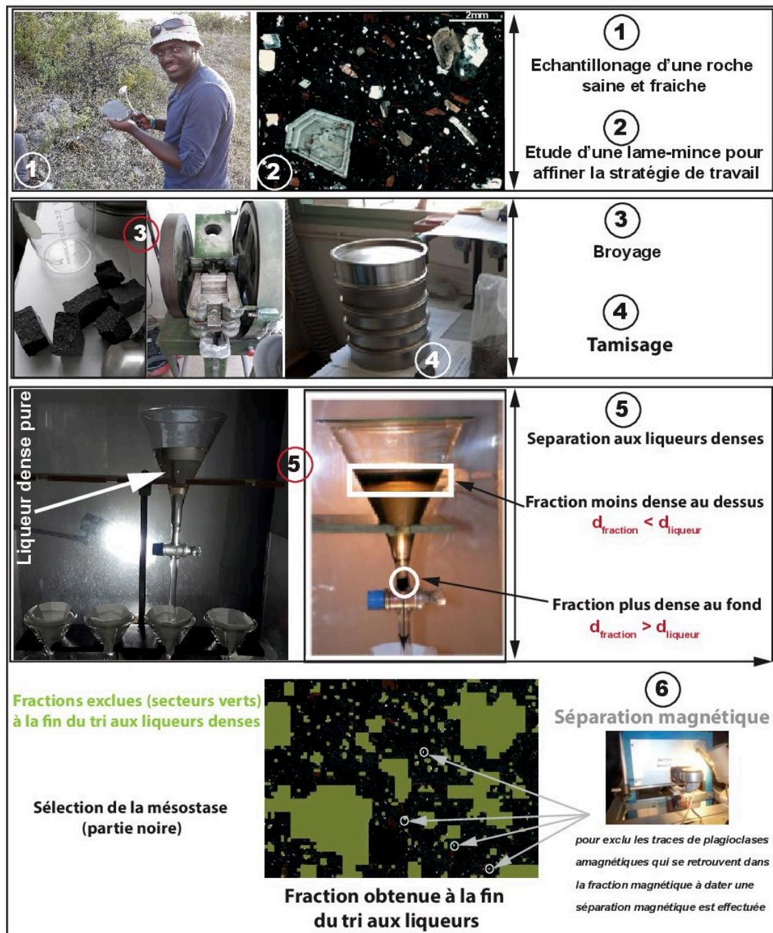
Fig. III-4 : Etapes majeures de préparation d'échantillons pour des datations K-Ar
