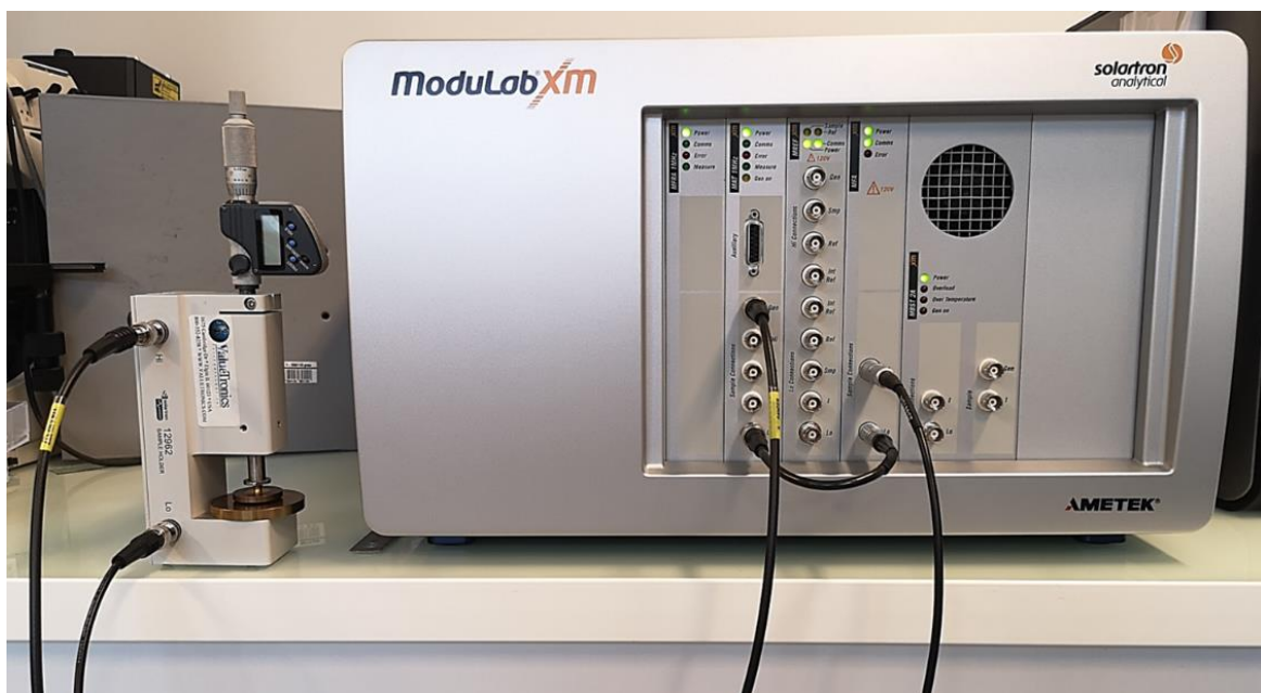
Figure III.13 – Analyseur Solartron et porte-échantillon utilisés pour les mesures DC et basses fréquences, ici branchés en mode balayage fréquentiel.
