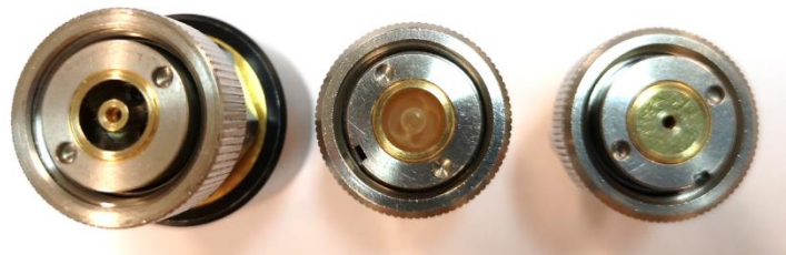
Figure III.17 – De gauche à droite : charge adaptée 50 ohms, circuit ouvert et court-circuit utilisés pour l'étalonnage des analyseurs
