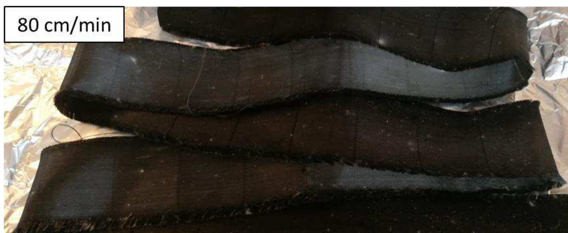
Figure II.23 – Clichés de tissus revêtus de NTC après synthèse par CVD continue, pour des vitesses de 30cm/min, 60cm/min et 80cm/min.
