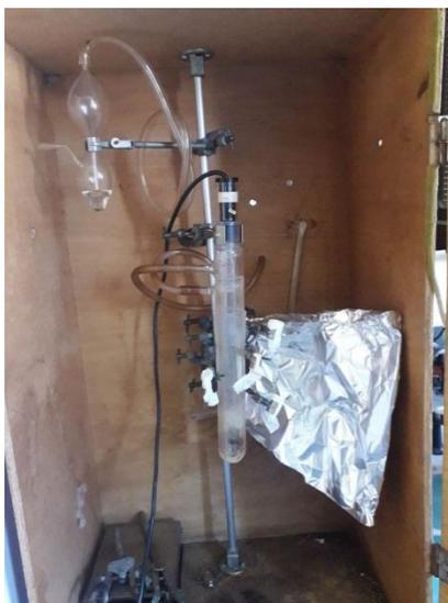
Figure II-16: lampe « Hanau TG 150 High-pressure mercury arc lamp »
