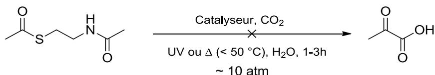
Catalyseur:  $\text{FeS}_2$ ,  $\text{ZnS}$  ou  $\text{MnCO}_3$
