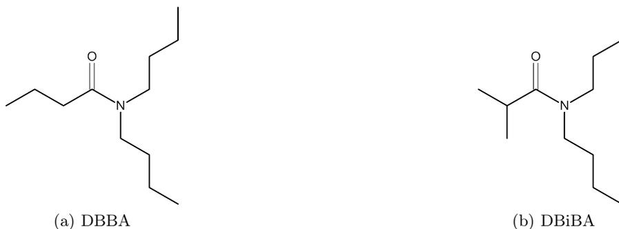
FIGURE 16 – Structures de monoamides DBBA (N,N-dibutylbutanamide) et DBiBA (N,N-dibutylisobutanamide).
