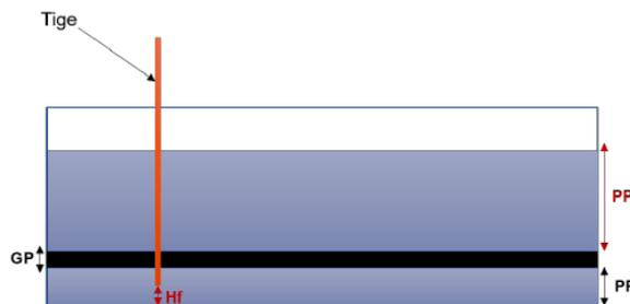
**Figure 4.31** Dispositif 3 : le disque est retiré, le milieu est cisailé par déplacement de la tige cylindrique de 0.5 cm de diamètre.
