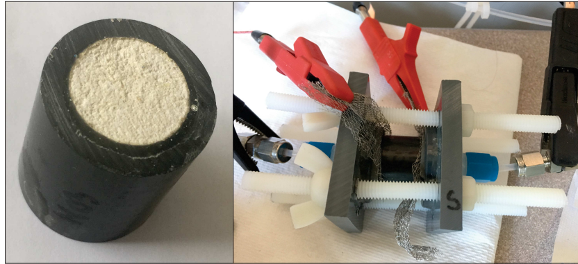
FIGURE 0.12 – a : Echantillon entouré du tube en PVC. b : Porte-échantillon.
