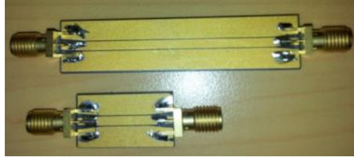
Figure I-25 : Lignes coplanaires réalisées en technologie LDS [121]
