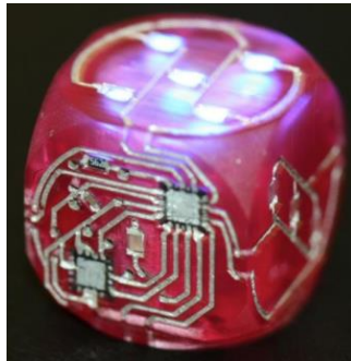
Figure I-31 : Système complexe d'électronique intégrée dans un dé [6]
