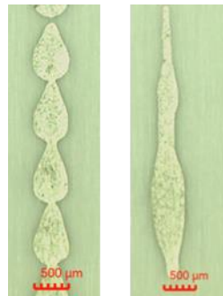
Figure II-26 : Photographies de gouttes avec t_{fall} < 0,1 ms
