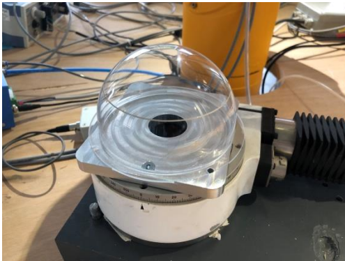
Figure III-54 : a) Radôme avec motif circulaire imprimé avec le robot 6 axes b) Montage réalisé en chambre anéchoïde
