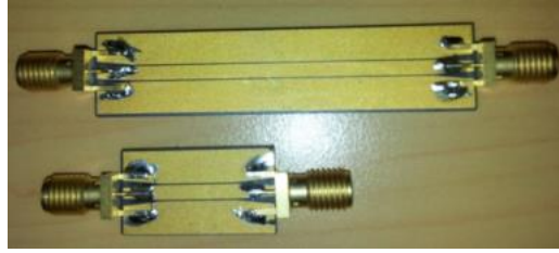
Figure I-25 : Lignes coplanaires réalisées en technologie LDS [121]
