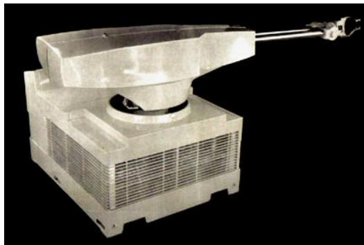
Figure I-18 : Unimate le premier robot industriel [99]
