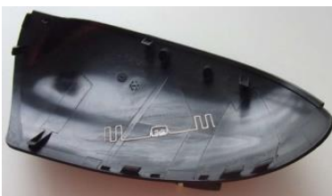
Figure I-23 : a) Rétroviseur identifié par RFID imprimé [76] b) Antenne imprimée sur une demi sphère [122]R
