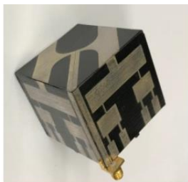
Figure I-35 : a) Rectenna triple bande (900 MHz, 1800 MHz et 2100 MHz) imprimée par sérigraphie puis pliée (origami) [135] b) Rectenna pour les fréquences allant de 1,8 GHz à 2,5 GHz, le circuit de redressement est visible dessous [136]
