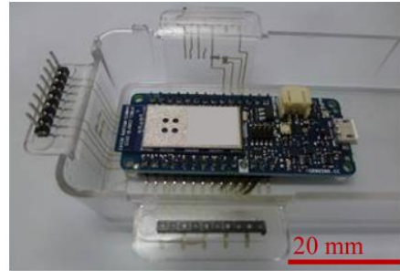
Figure I-32 : Boîtier intelligent réalisé en électronique moulée [18] a) vue de dessous b) vue de dessus
