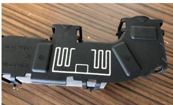
Figure III-48 : a) Tag RFID imprimé sur une pièce industrielle b) Pièce avec tags RFID imprimés en position d'impression
