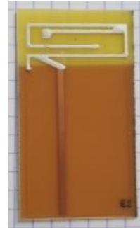
Figure III-44 : a) Mesure du paramètre S_{11} sur 4 antennes imprimées sur du FR4 et simulation b) Photographie d'une antenne imprimée sur FR4
