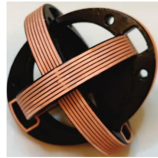
Figure I-33 : a) Inductance émettrice b) inductance réceptrice sur PCB c) Inductance réceptrice réalisée en technologie LDS [10]
