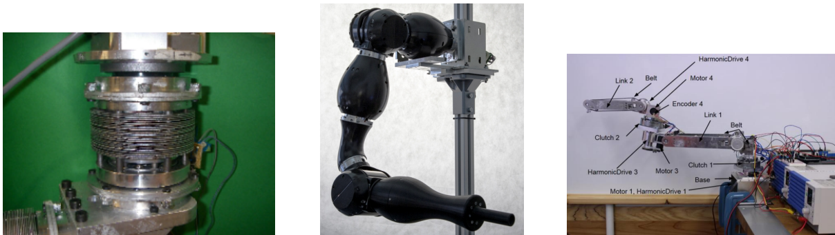
(a) Actionneur incluant un embrayage à friction, [LAUZIER et GOSSELIN, 2011]. (b) Bras robot intégrant des actionneurs avec embrayage, [KASHIRI et al., 2014]. (c) Bras robot intégrant des actionneurs avec embrayage, [SCHMITZ et al., 2015].
