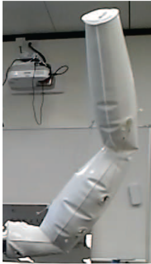
(a) Robot gonflable à six degrés de libertés, [QI et al., 2014].
