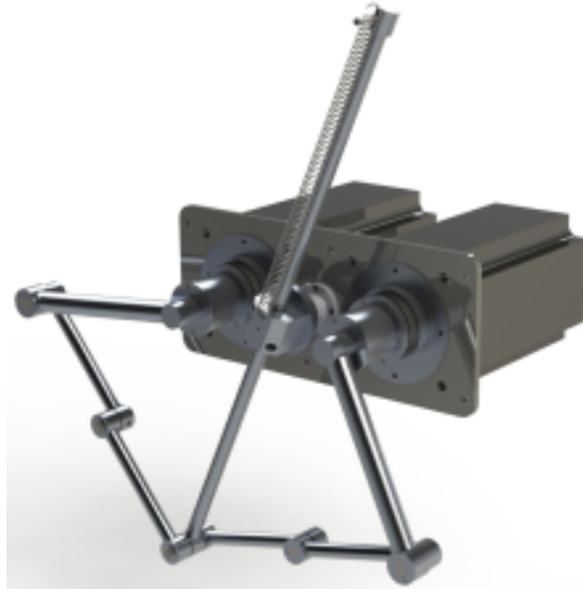
FIGURE 2.3 – Conception préliminaire du robot R-MIn utilisé pour le calcul de l'espace de travail.
