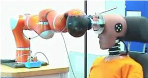
FIGURE 1.21 – Un mannequin est utilisé [HADDADIN et al., 2007] pour reproduire fidèlement le corps humain dans un cas semi-contraint.
