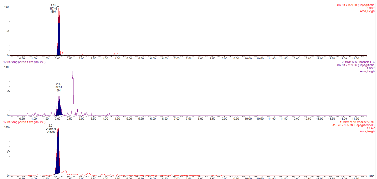
Figure 12. Chromatogrammes des transitions ioniques de l'échantillon de sang postmortem contenant (du haut vers le bas) 2 transitions de dapagliflozine et 1 transition de l'IS (dapagliflozine-d5), la concentration était de 2,5 ng/mL
