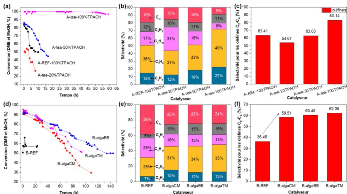
**Figure 4.** (a, d) Conversion du méthanol et du DME en hydrocarbures en fonction du temps de réaction en continu (time-on-stream, TOS), (b, e) Sélectivité envers les différents hydrocarbures. (C<sub>2</sub>H<sub>4</sub>, C<sub>3</sub>H<sub>6</sub>, C<sub>4</sub>H<sub>10</sub>, C<sub>4</sub>H<sub>8</sub> et C<sub>5</sub><sup>+</sup>), (c, f) Sélectivité vers les oléfines (C<sub>2</sub>-C<sub>4</sub>). (450 °C, TOS = 1 h, et WHSV = 2 h<sup>-1</sup>)
