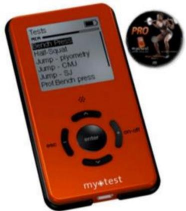
**Figure 20.** Illustration de l'accéléromètre MyotestPro.
