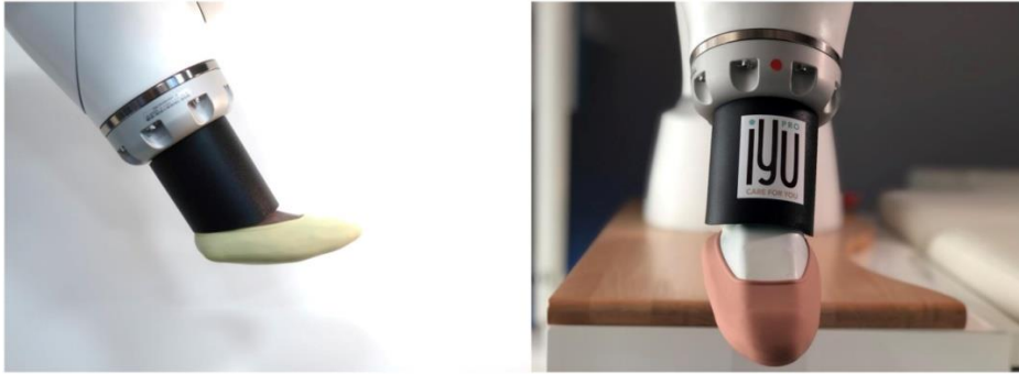
Figure 26. Illustrations de la main de massage de la solution iYU® Pro avec son système articulé et sa chaussette en silicone.
