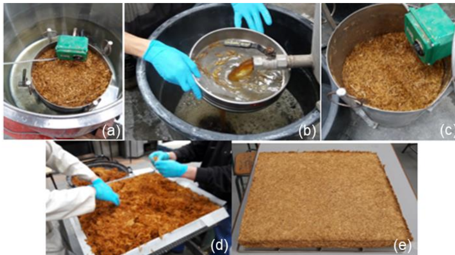
Figure II-17 : Production de panneaux de résidus de paille de colza – (a) macération, (b) filtration, (c) résidus de paille de colza, (d) moulage, (e) panneau de résidus de paille de colza démoulés.
