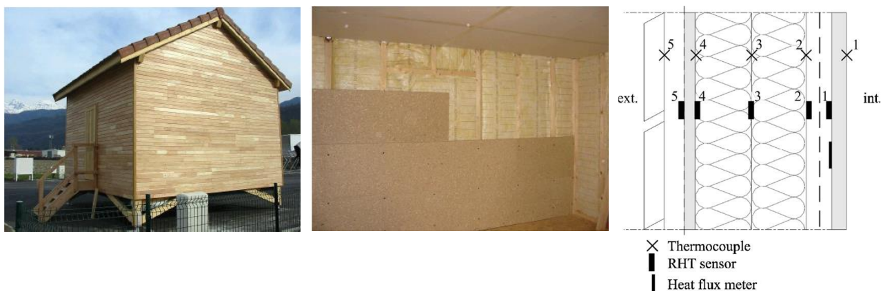
Figure I-38 : Vue de la cellule, composition et instrumentation des parois (Piot et al. 2011)
