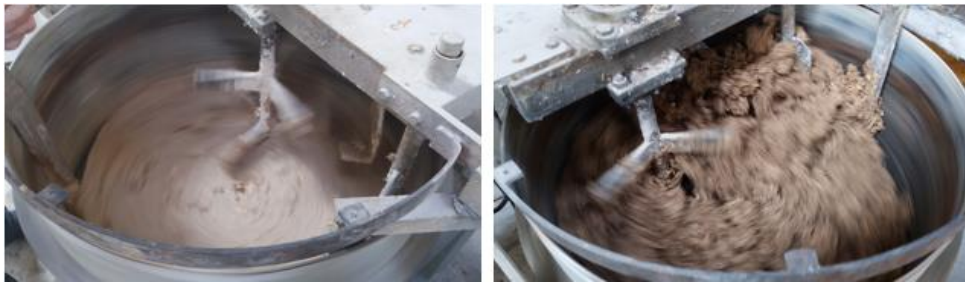
Figure II-9 : Production du composite – production de la pâte (gauche) et mélange avec le chanvre (droite)
