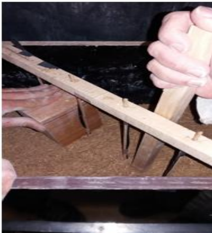
Figure II-23 : capteurs placés dans le terre-chanvre
