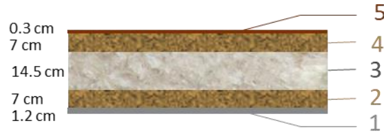
Figure II-19 : Composition de la paroi en résidus de colza
