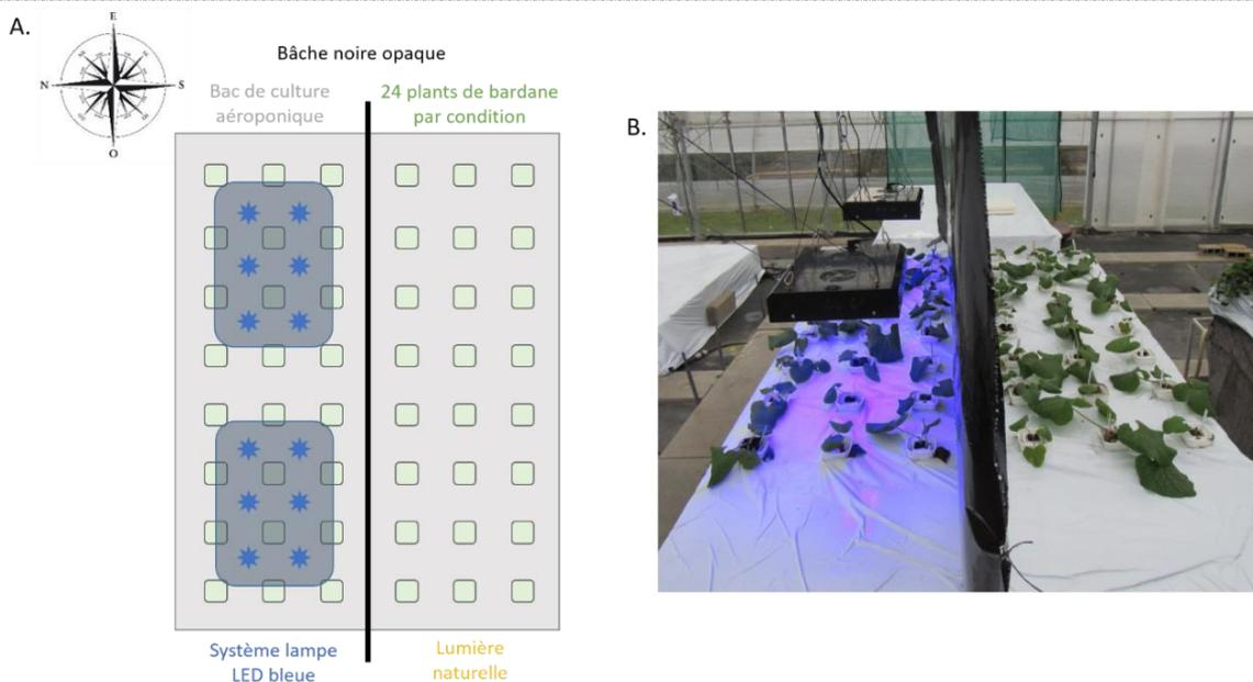
Figure II-5 : (A) Schéma du dispositif mis en place pour l'élicitation de la bardane en culture d'hydroponie active et (B) Photographie du dispositif
