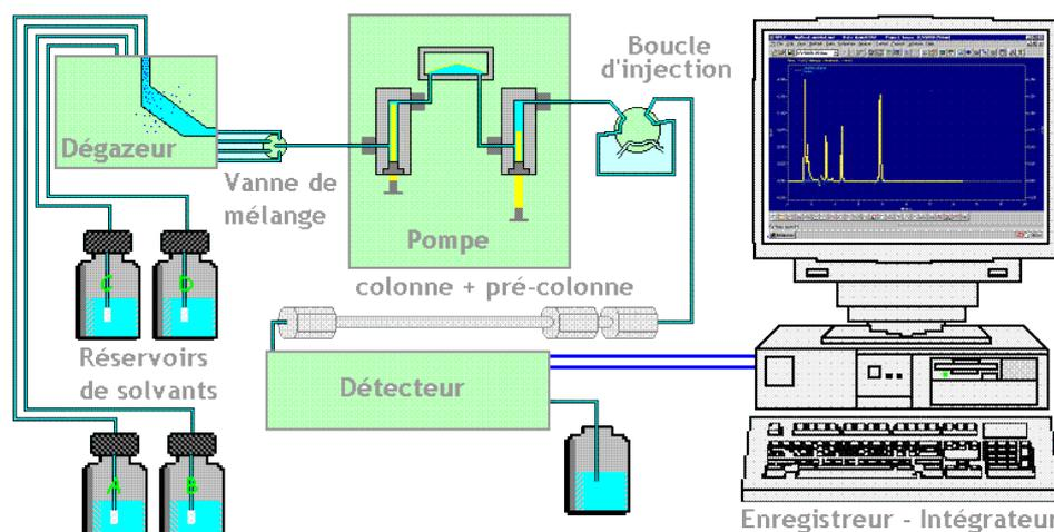
Figure II-8 : Schéma simplifiée d'une chaîne chromatographique HPLC, Le 2020
