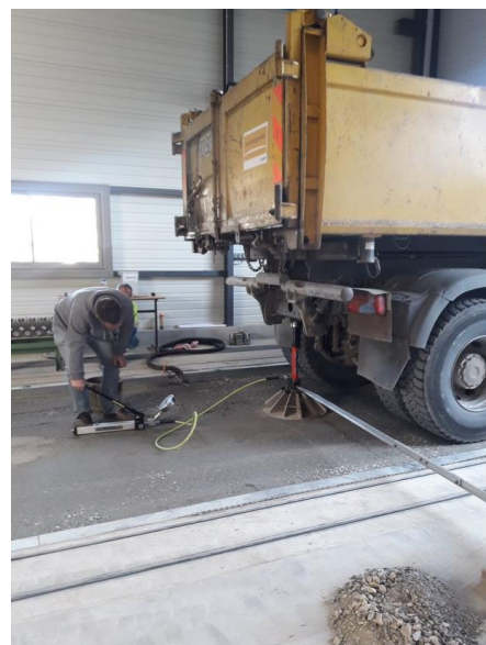
Figure II-4 : Essai de plaque exécuté sur la plateforme de la fosse
