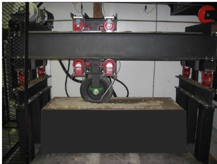
Figure I-24 : Utilisation du simulateur sur un échantillon de chaussée non revêtue (d'après Juneau & Pierre, 2008)
