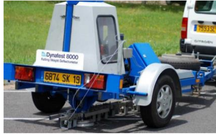
Figure I-45 : Le Falling Weight Deflectometer (d'après Picoux & al., 2017)
