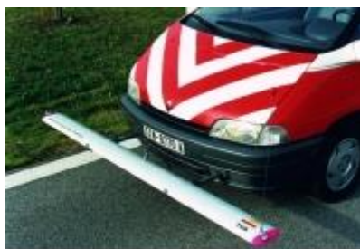
Figure I-42 : Transversoprofilomètres à ultrason (source : http://www.cerema.fr )
