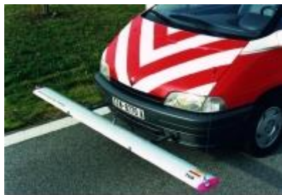
Figure I-42 : Transversoprofilomètres à ultrason (source : http://www.cerema.fr )
