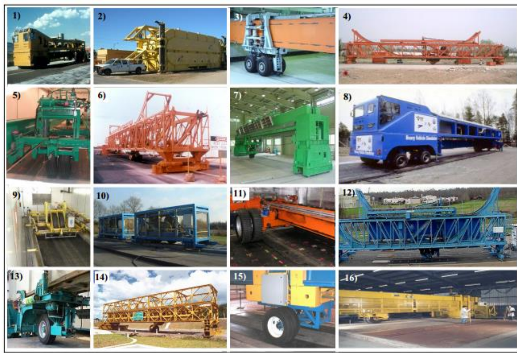
Figure I-25 : Simulateurs de trafic lourd linéaires. 1) Afrique du Sud - 2) Texas - 3) Japon - 4) Chine- 5) Ohio- 6) Australie - 7) Corée du Sud- 8) Norvège - 9) Danemark - 10) France- 11) Suisse -12) Louisiane - 13) Pays-Bas - 14) Brésil -15) Kansas 16) (AFD40), s. d.)
