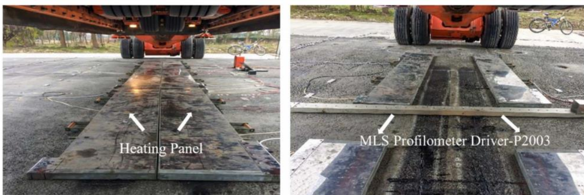
Figure I-28 : Essais en vrai grandeur effectués dans des conditions de températures contrôlées (d'après Ling et al., 2020)
