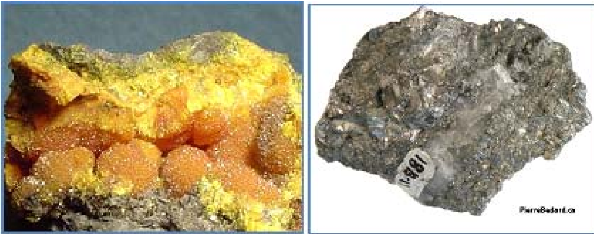
Figure III- 6 : (a) Cristaux d'orpiment As_2S_3 (Barney's Canyon, Utah) photo : R.M. Lavinsky, 2012, wikimedia (b) Arsénopyrite FeAsS gris métallique et quartz blanc. École Polytec. de Montréal, photo : P. Bédard 2009
