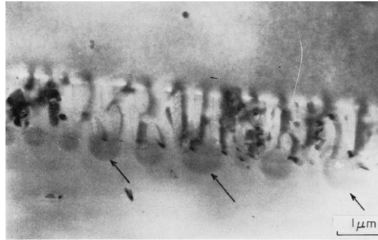
Figure I. 48: Image MET d'un alliage Al-6Zn-3Mg exposé à 70 °C à de l'air saturé en vapeur d'eau durant trois jours [76].
