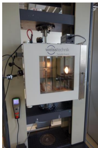
Figure annexe 5: Machine d'essai avec sa chambre climatique utilisée pour les essais d'endurance au CRT Ottobrunn
