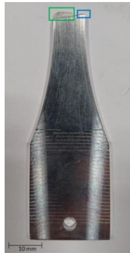
Figure IV. 36: Délimitation des deux zones : zone plane à 90^\circ par rapport à l'axe de sollicitation (encadrée en bleu), zone inclinée d'environ 45^\circ par rapport à la direction de la sollicitation (encadrée en vert)
