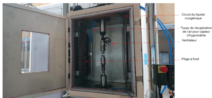
Figure II. 2: Enceinte climatique développée et conçue à Pprime
