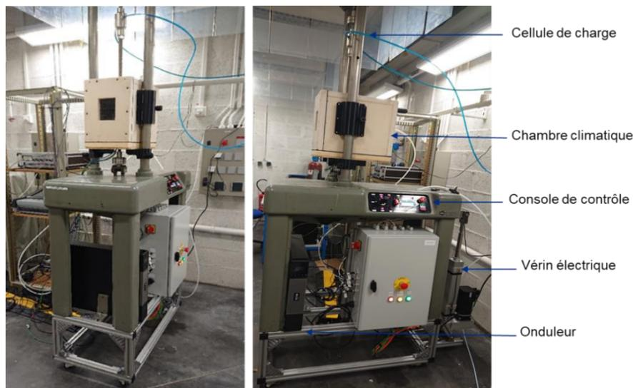
**Figure II. 11:** Images du banc d'essai VLCF
