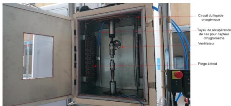
**Figure II. 2:** Enceinte climatique développée et conçue à Pprime
