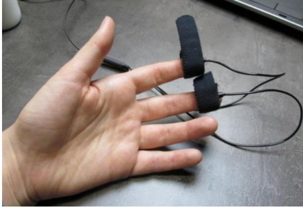
Figure 16 : Illustration du positionnement des électrodes réutilisables sur les phalanges distales de l'index et du majeur de la main non-dominante d'un participant. Un électrolyte, le gel 101, a été disposé à l'intérieur des cavités des électrodes.
