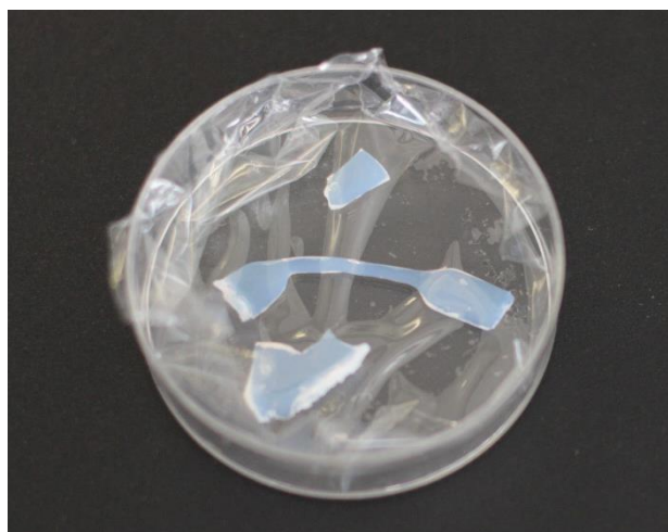
Figure A.2 : Photographie d'un film de PMMA-PDMS-PMMA
