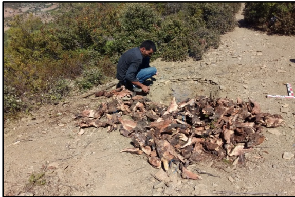
Photo 28 à 35: Principales étapes de la pyrolyse en forêt de Timdiouane à Jbel Oudka : démarrage du feu, entassement des souches, combustion à l'air, fermeture par des pierres lutées à l'argile et défournement.
