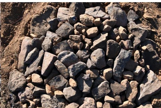
Fig. 4 Fermeture de la charbonnière avec un lit de pierres
