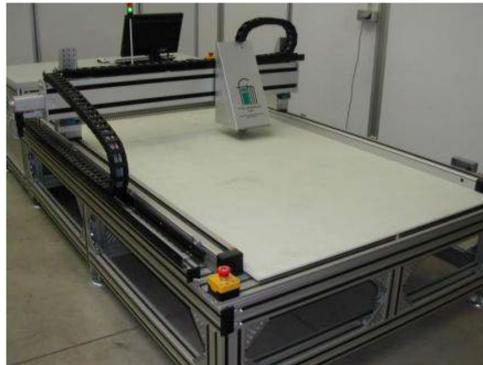
FIGURE 1.4 – Contrôle micro-onde de matériau composite plan [16].
