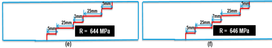
Figure2-7 Etude paramétrique de la longueur de recouvrement sur la résistance. (e) Une petite L_r=3\text{mm} à cœur ; (f) Une petite L_r=7\text{mm} à cœur
