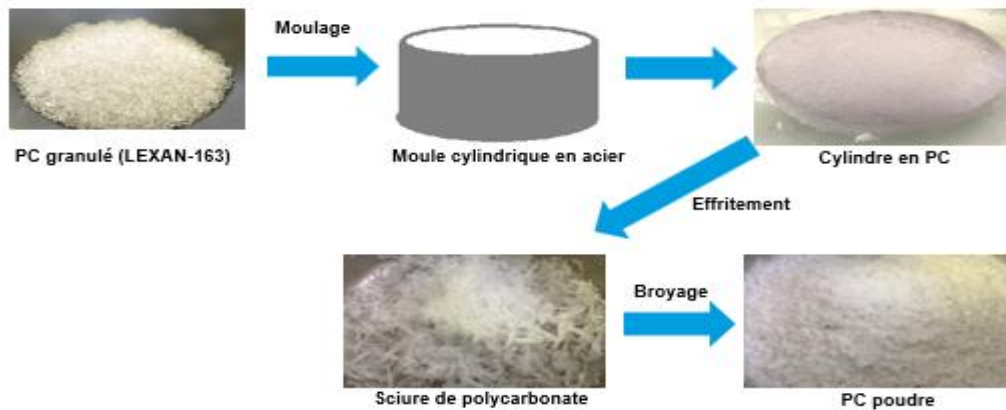
Figure 3-14 Processus de la réduction des granulés de PC en poudre
