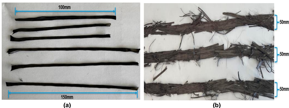
Figure 3-19 Remise en forme de fibres de carbone recyclées (a) « Semi-longes » de fibres de carbone de 100 à 150 mm ; (b) Bandes continues de fibres de carbone recyclées de 50mm de largeur.
