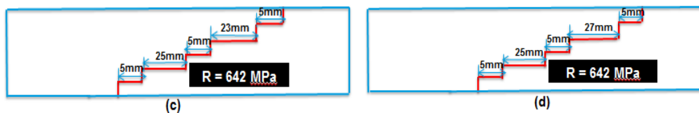
Figure2-7 Etude paramétrique de la longueur de recouvrement sur la résistance. (c) Une grande L_r=23\text{mm} à l'intérieur ; (d) Une grande L_r=27\text{mm} à l'intérieur
