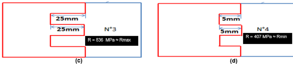
Figure 2-10 Schéma du modèle des joints en «emboîtement». (c) L_r=25\text{mm} partout ; (d) L_r=5\text{mm} partout
