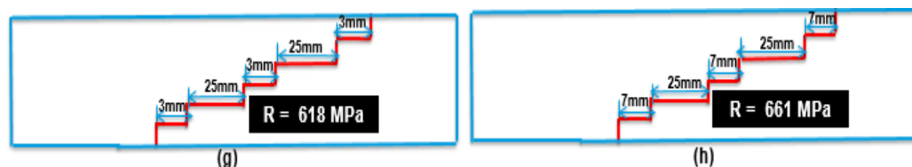
Figure2-7 Etude paramétrique de la longueur de recouvrement sur la résistance. (g) 3 petites L_r=3\text{mm} répartis symétriquement ; (h) 3 petites L_r=7\text{mm} répartis symétriquement
