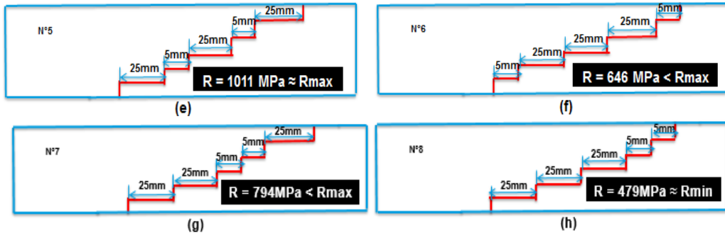
Figure2-3 Schéma du modèle des joints en «escalier» . (e) 2 défauts à cœur "éloignés" l'un de l'autre et symétriques ; (f) 2 défauts sur les bords ; (g) 2 défauts à cœur et adjacents ; (h) 2 défauts en peau et adjacents
