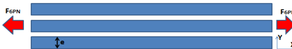
Figure1-25 (b) Architecture simple d'une plaque avec fibres de carbone continues (3 couches = 6 plis)
