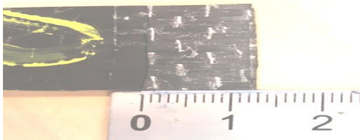
Figure1-24 Longueur de recouvrement mesurée après essai de traction ( L_{Théorique}=15mm et L_{mesurée}=13mm )
