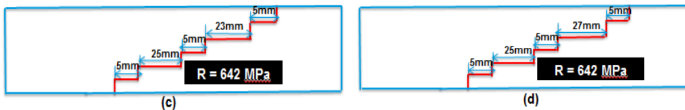
Figure2-7 Etude paramétrique de la longueur de recouvrement sur la résistance. (c) Une grande L_r=23\text{mm} à l'intérieur ; (d) Une grande L_r=27\text{mm} à l'intérieur
