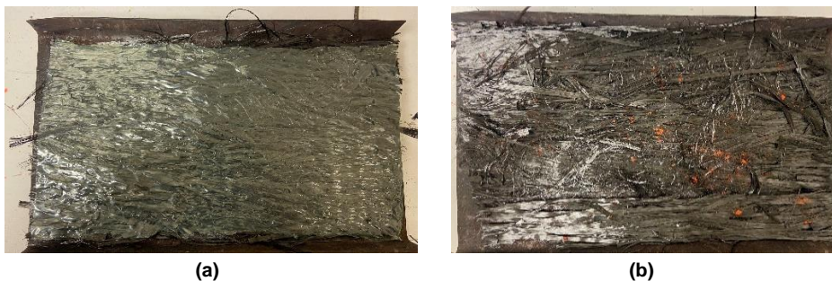
Figure 3-21 Fixer la forme du pli de FCr (a) Pli de FCr pour fabriquer la plaquer du composite FCr/PA6 film ; (b) Pli de FCr pour fabriquer les plaques des composites FCr/PC film et FCr/époxy(A-1)
