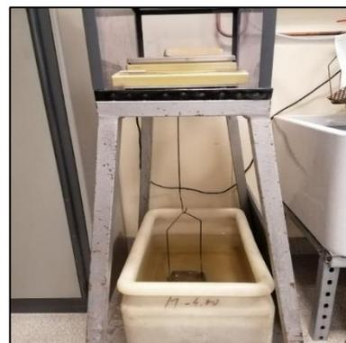
Figure II-26: Système de pesée hydrostatique
