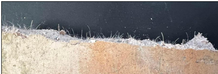
Figure V-13: Dispersion des fibres de lin
