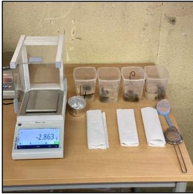
Figure II-11: Immersion des fibres dans l'eau
