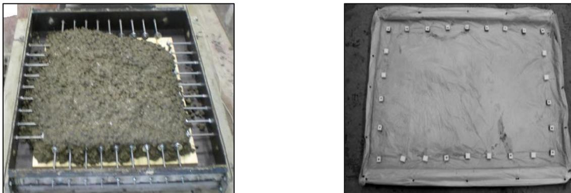
**Figure IV-7: Exemple d'essais avec des tiges localisés au bord et au fond des moules (Choi et al., 2014; Ruiz-Ripoll et al., 2013)**
