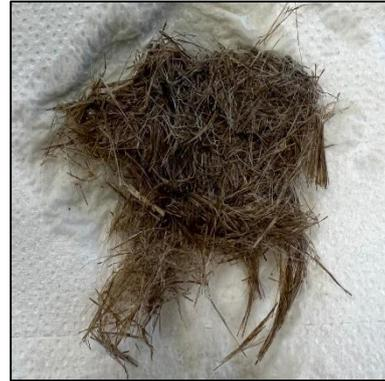
Figure II-12: Les fibres après séchage superficiel
