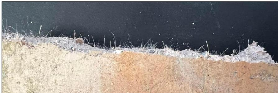
**Figure V-13: Dispersion des fibres de lin**
