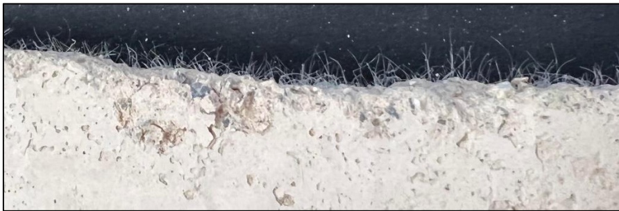
Figure V-12: Dispersion des fibres de polypropylènes
