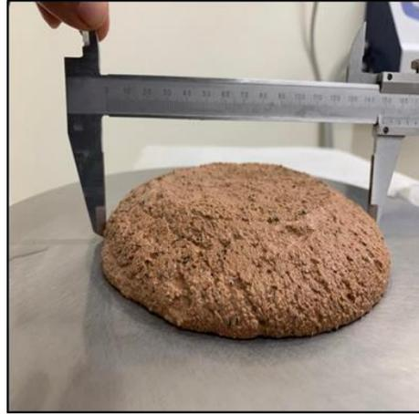
Figure II-20: Essai à la table à secousses
