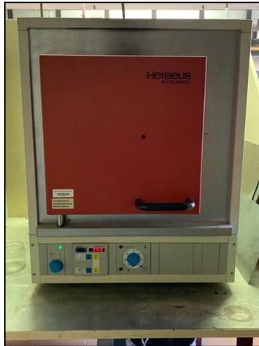
Figure V-33: Four utilisé pour chauffer les éprouvettes
