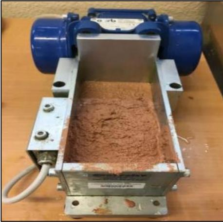
Figure II-19: Essai au maniabilimètre
