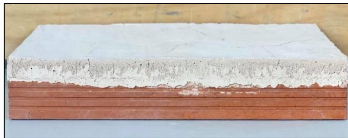
Figure IV-15: Illustration d'un échantillon de mortier sur la brique
