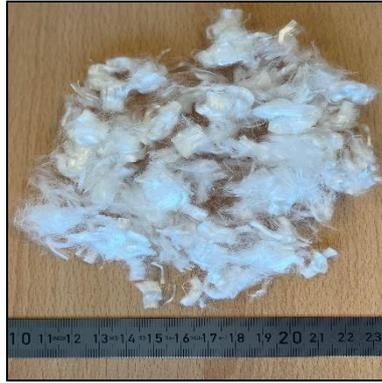
Figure II-1: Les fibres polypropylènes
