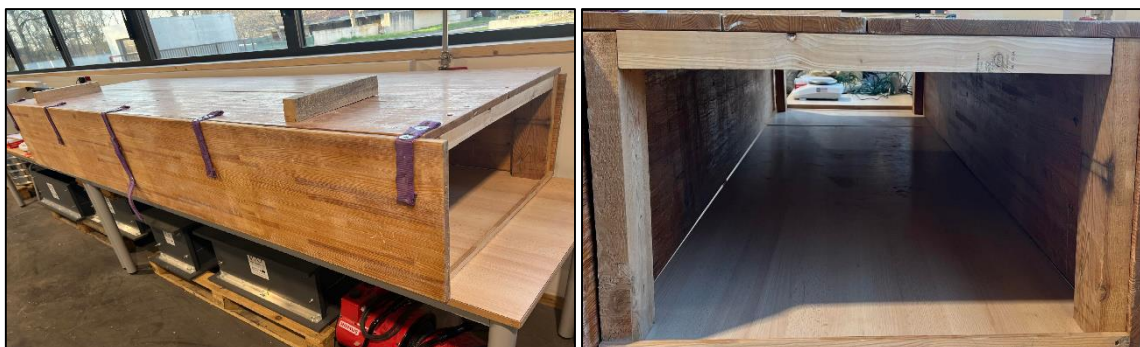
Figure IV-8: Le tunnel ventilé utilisé pour tester la sensibilité à la fissuration au jeune âge
