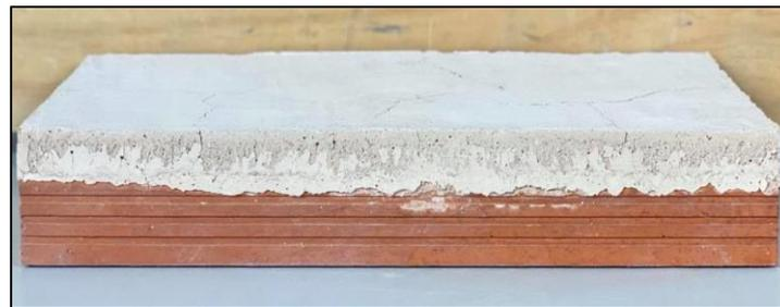
**Figure IV-15: Illustration d'un échantillon de mortier sur la brique**
