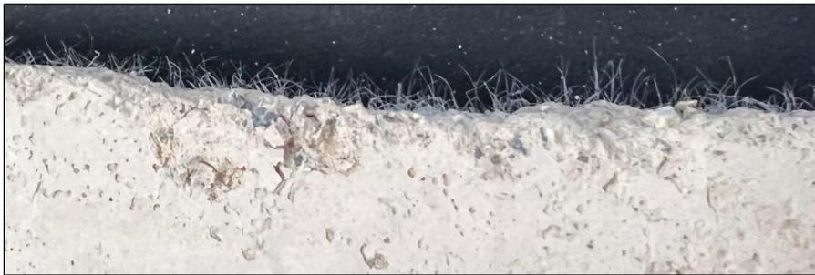
**Figure V-12: Dispersion des fibres de polypropylènes**
