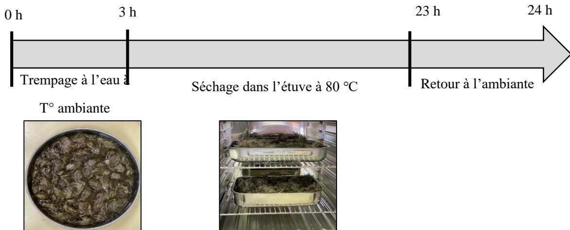
Figure II-8: Méthode de prétraitement testée sur les fibres de lin
