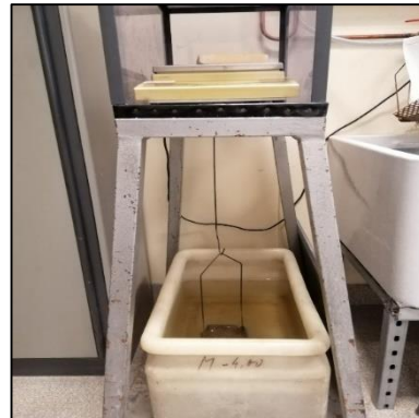
Figure II-26: Système de pesée hydrostatique
