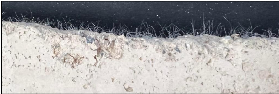
Figure V-12: Dispersion des fibres de polypropylènes
