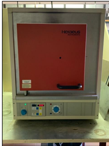
Figure V-33: Four utilisé pour chauffer les éprouvettes
