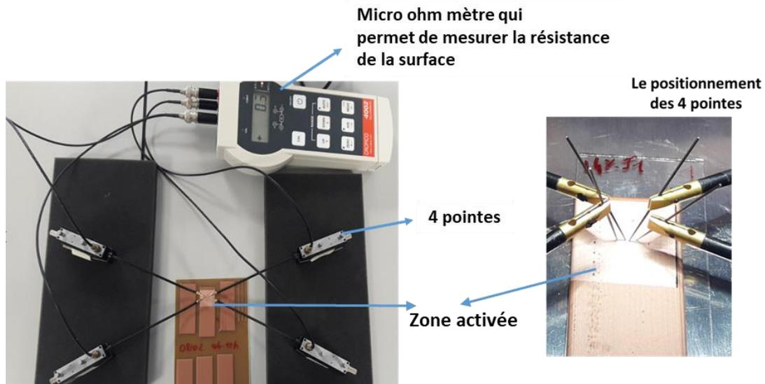
Figure 63 : Illustration de la mesure 4 points (micro ohm mètre Coprico® 4001 et 4 pointes) la résistance carrée est égale à  $4,53 \times R_{\text{microohm mètre}}$ .
