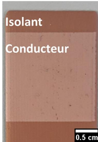
Figure 40 : Couche d'Eoprom® extrudée (PEM) et activée en surface au laser.
