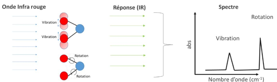
Figure 20 : Schéma de principe de la spectroscopie infrarouge.
