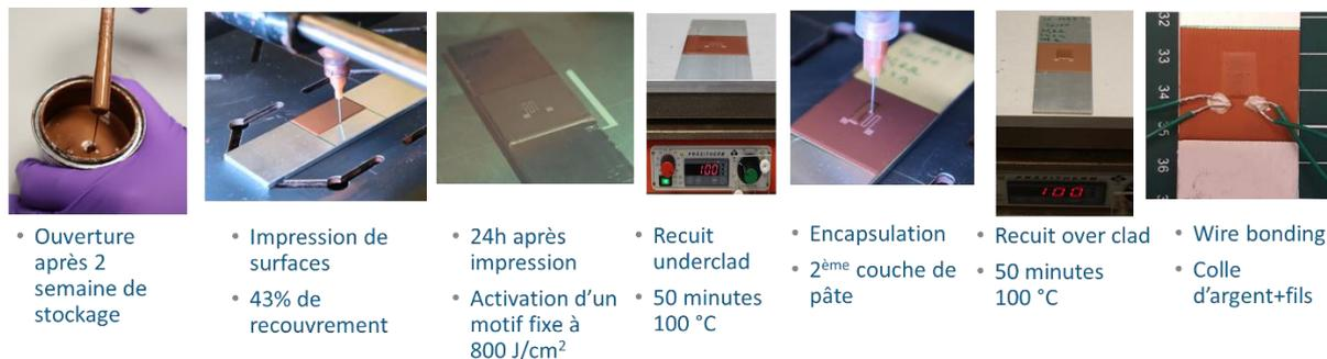
**Figure 29 : Procédé complet d'impression d'une fonction électronique par activation de pâte Eoprom®.**
