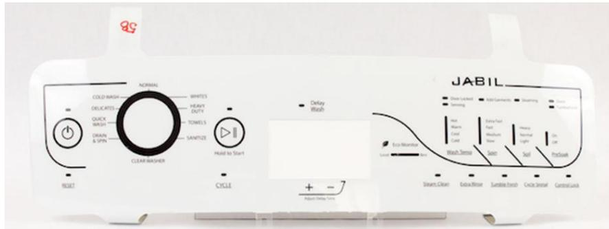
Figure 10 : Interface homme machine fabriquée par JABRIL qui associe l'électronique et la décoration.
