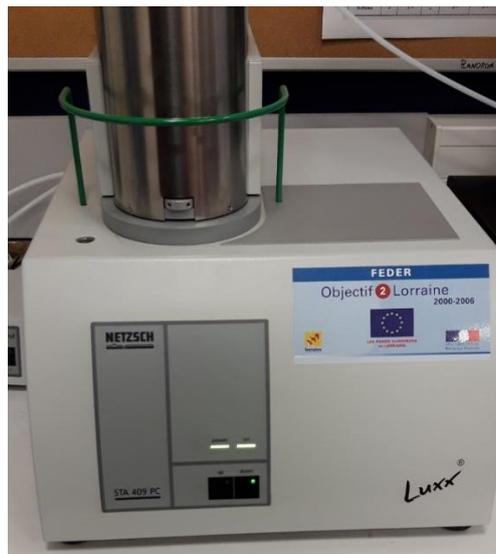
**Figure 59 : Appareil TGA (Netzsch STA 409 PC)-IUT Moselle Est Université de Lorraine.**
