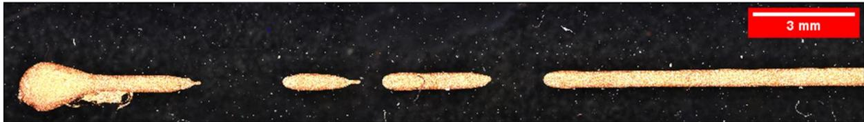
Figure 6 : Discontinuité du dépôt au-delà de  $30\ \text{mm/s}$ .
