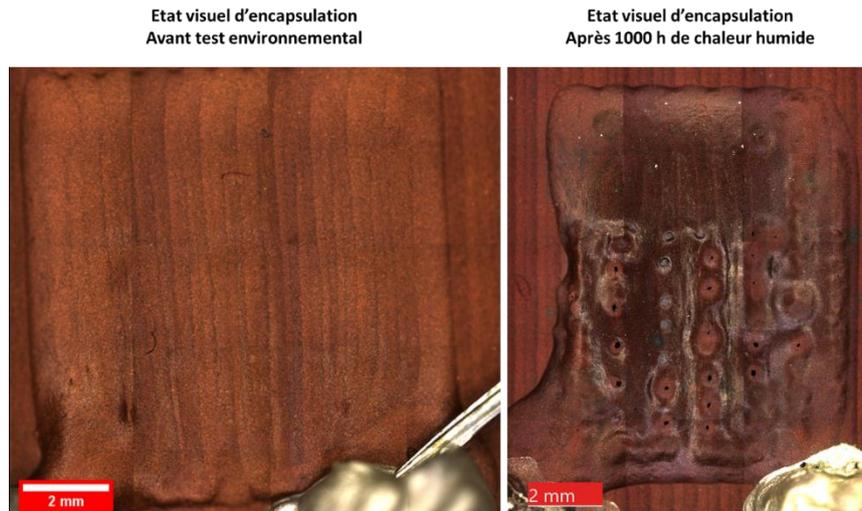
**Figure 5 : Images au microscope optique de l'état de l'encapsulation avant et après le test de chaleur humide**
