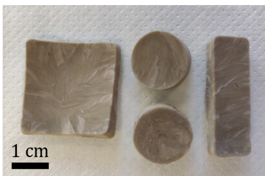
FIGURE 2.6 – Aérogels synthétisés dans des moules de différentes formes.
