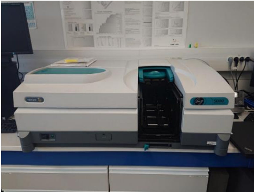
Figure 4-6 - Spectromètre Cary 5000 avec son module de mesure en transmission du laboratoire d'expertise du CNES
