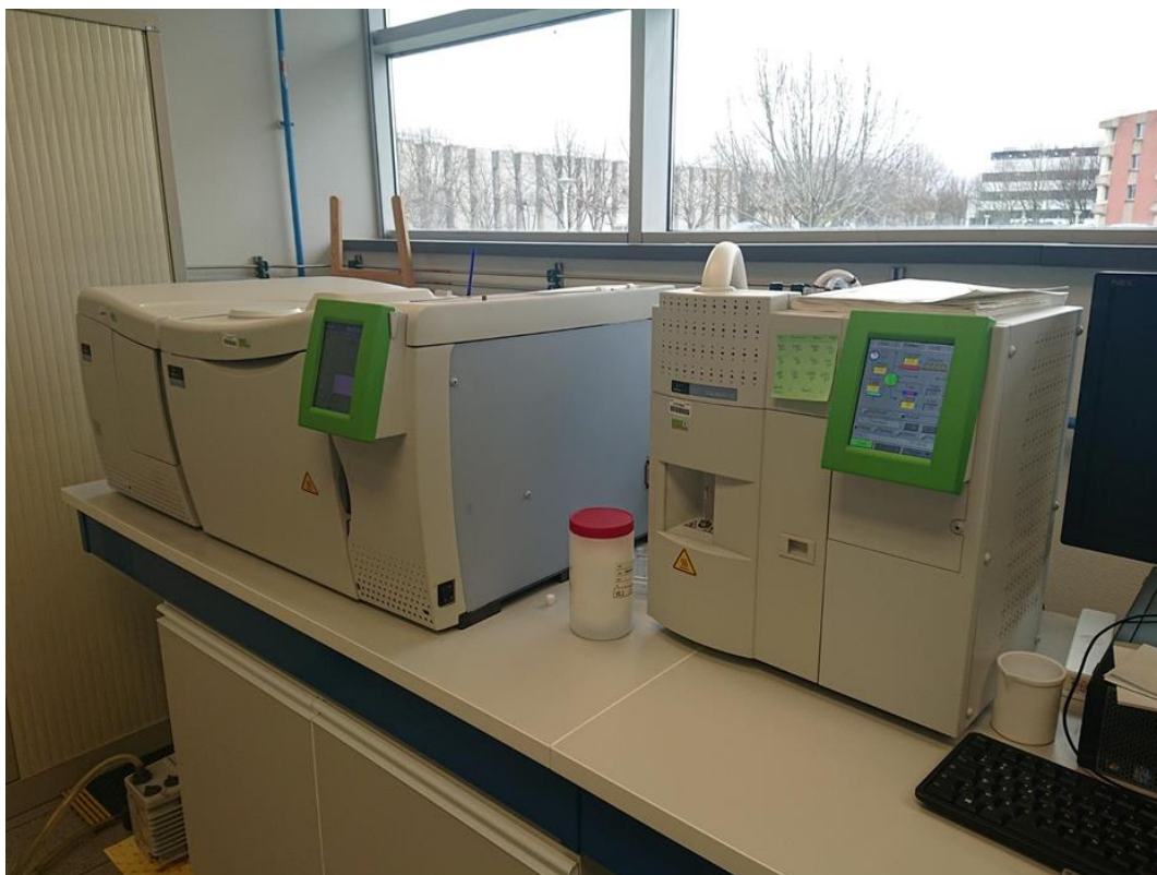
Figure 4-20 - TD-GC-MS du laboratoire d'expertise du CNES. A droite le désorbeur thermique et à droite les deux modules chromatographie gazeuse et le spectromètre de masse
