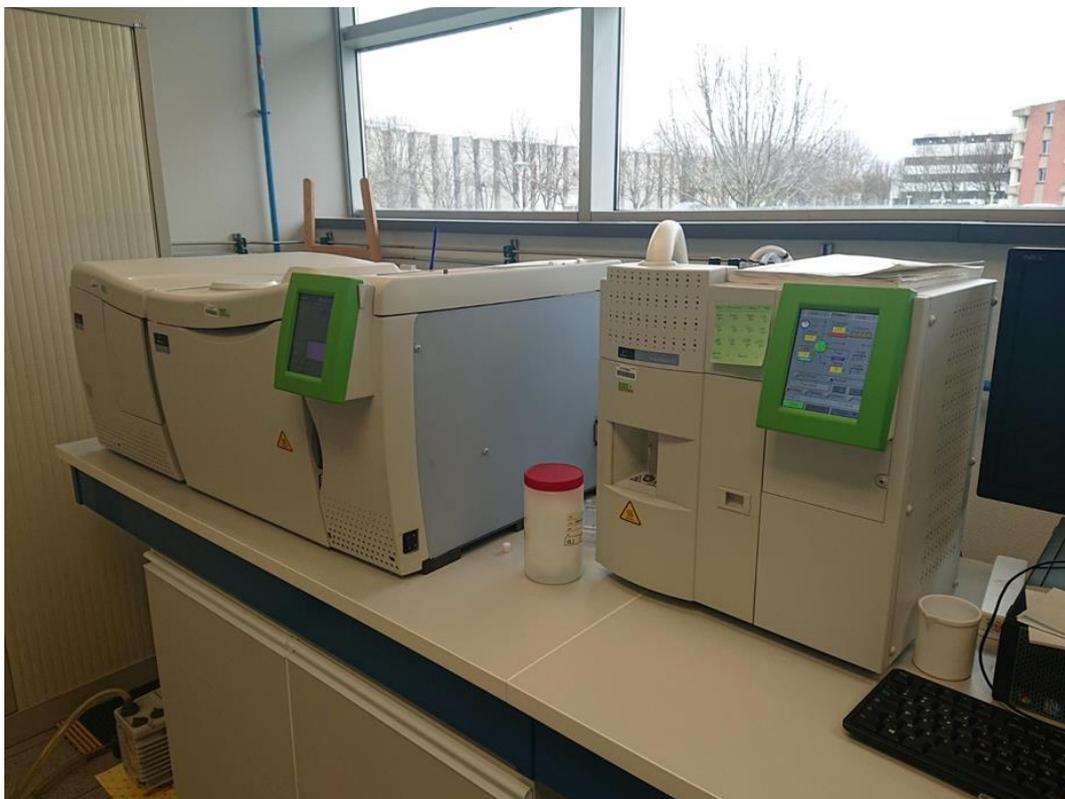
**Figure 4-20 - TD-GC-MS du laboratoire d'expertise du CNES. À gauche le désorbeur thermique et à droite les deux modules chromatographie gazeuse et le spectromètre de masse**
