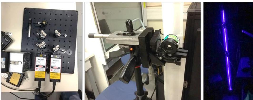
**Figure 3-33 - A gauche, système lasers décrit plus haut. Au centre, wattmètre optique Newport monté sur sa platine de translation. A droite, raie laser à 445 nm réalisé à l'aide du système laser.**
