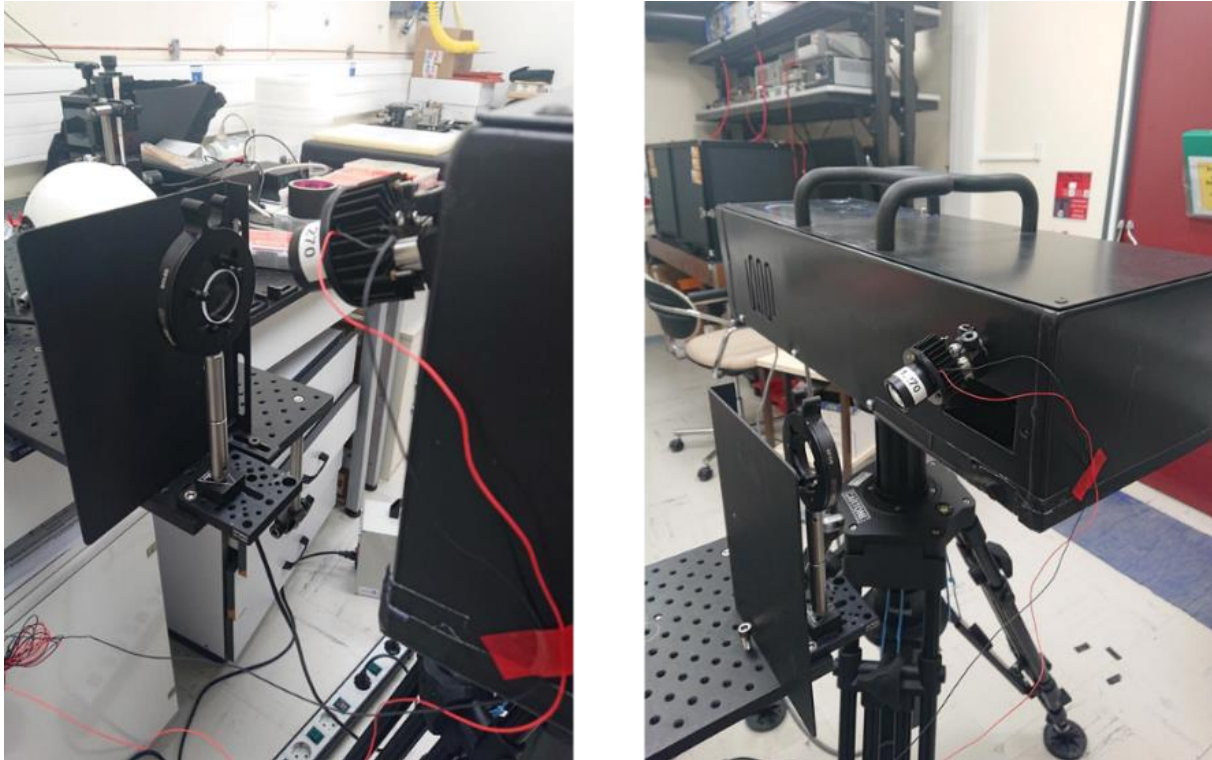
Figure 4-29 - Analyse des échantillons de contaminant par l'imageur hyperspectral. L'anneau de LED a été retiré au profit d'une seule LED à 270 nm, afin de reproduire les paramètres d'acquisition utilisés avec le spectromètre OceanOptics. Les mesures ont été réalisées en salle laser à accès restreint afin de prévenir le risque UV.
