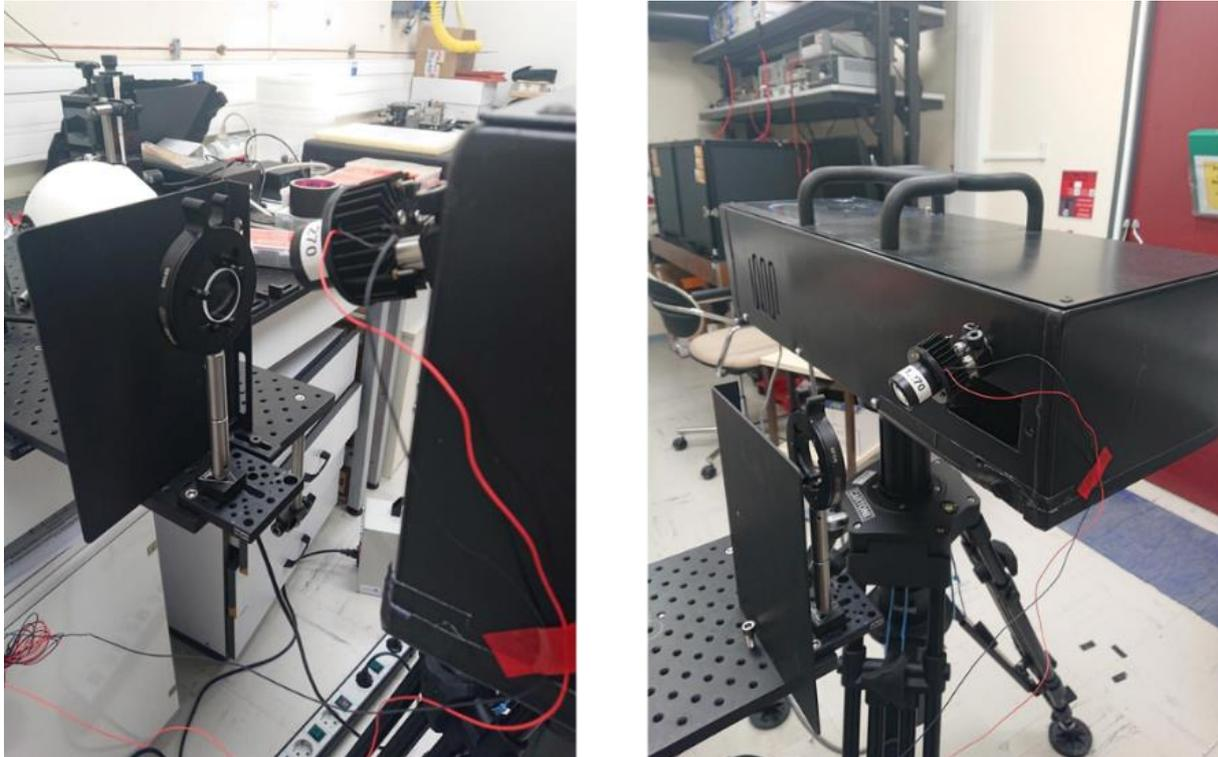
**Figure 4-29 - Analyse des échantillons de contaminant par l'imageur hyperspectral. L'anneau de LED a été retiré au profit d'une seule LED à 270 nm, afin de reproduire les paramètres d'acquisition utilisés avec le spectromètre OceanOptics. Les mesures ont été réalisées en salle laser à accès restreint afin de prévenir le risque UV.**
