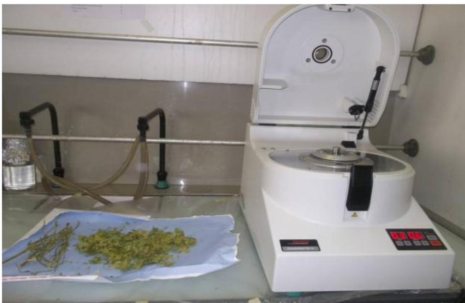
Figure 15 : Broyeur des végétaux avec broyeur rapide à rotor « Pulvérisette 14» (Fritsch)
