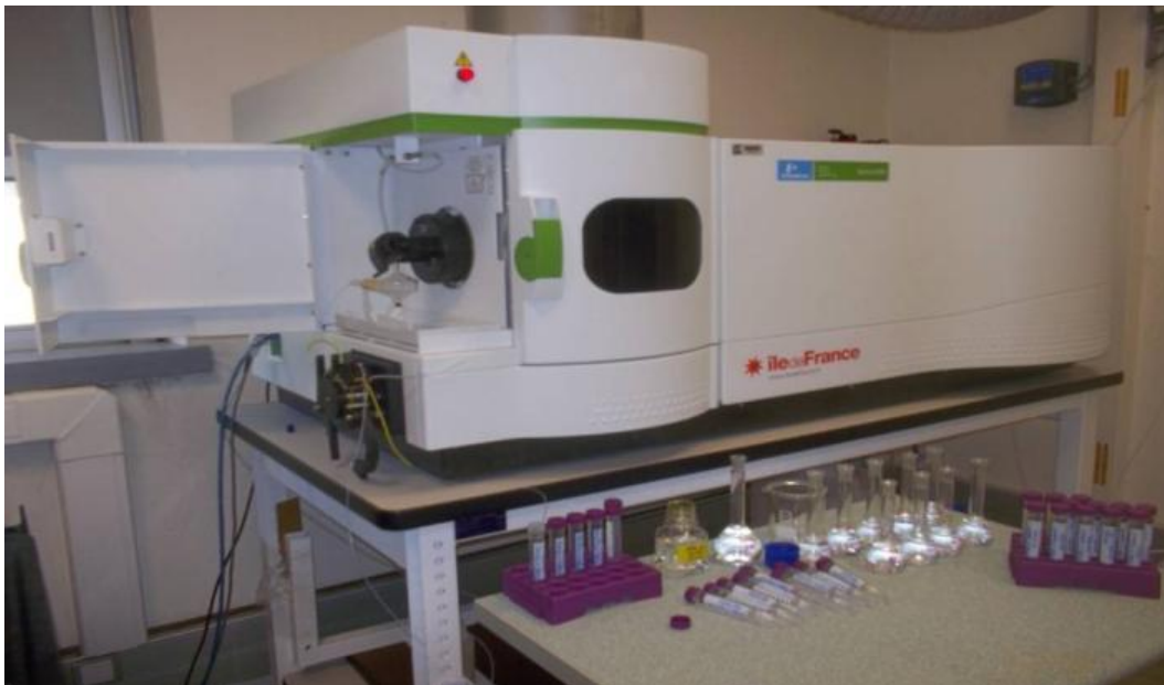
Figure 18 : Appareil ICP-OES (Perkin Elmer Optima 8300) pour le dosage des éléments traces dans les végétaux
