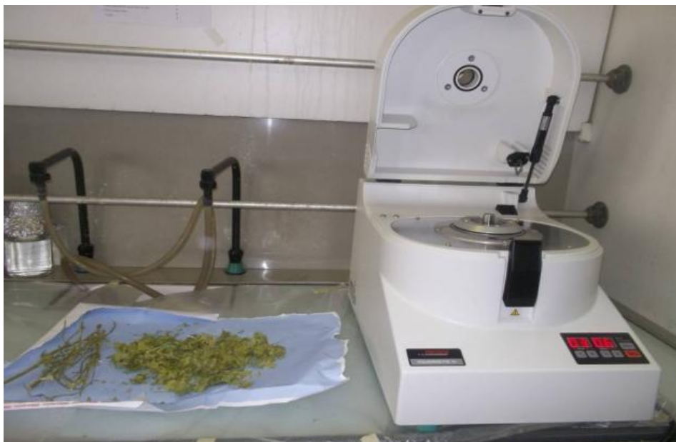
Figure 15 : Broyeur des végétaux avec broyeur rapide à rotor « Pulvérisette 14» (Fritsch)
