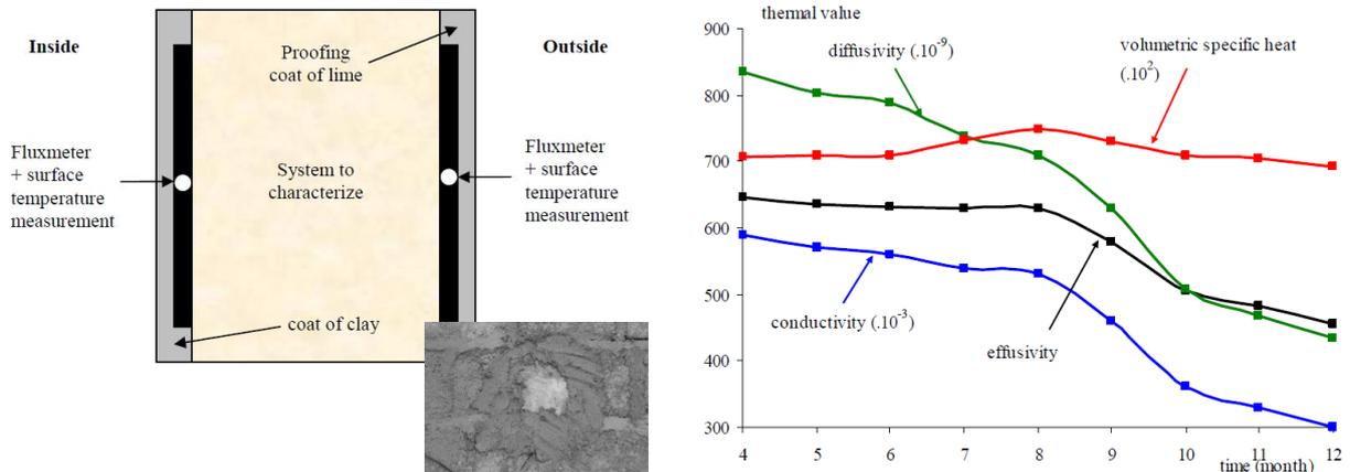
Figure I-36 : implantation des capteurs (Wu et al. 2010)
