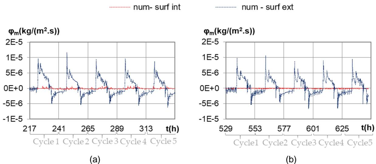
Figure III-30 : Flux d'humidité numériques sur les surfaces intérieures et extérieures au cours des cycles journaliers avec ensoleillement pour le climat de : (a) Rennes, (b) Brest.
