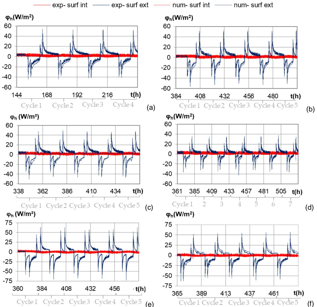
Figure III-18 : Flux de chaleur expérimentaux et numériques sur les surfaces intérieures et extérieures au cours des cycles journaliers pour le climat de : (a) Rennes, (b) Toulouse, (c) Strasbourg, (d) Brest, (e) Kairouan, (f) Djerba.
