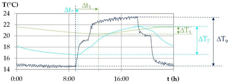
Figure II-52 : Identification de la phase de décalage  $\Delta t$  entre la surface et un point donné et de l'amplitude à la surface et en un point donné (exemple de l'amplitude de température  $\Delta T$ ).
