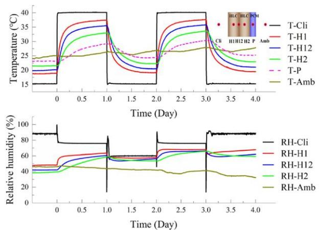
Figure I-21 : Température et humidité relative à différentes positions lorsque le MCP est placé côté ambiance intérieure du mur
