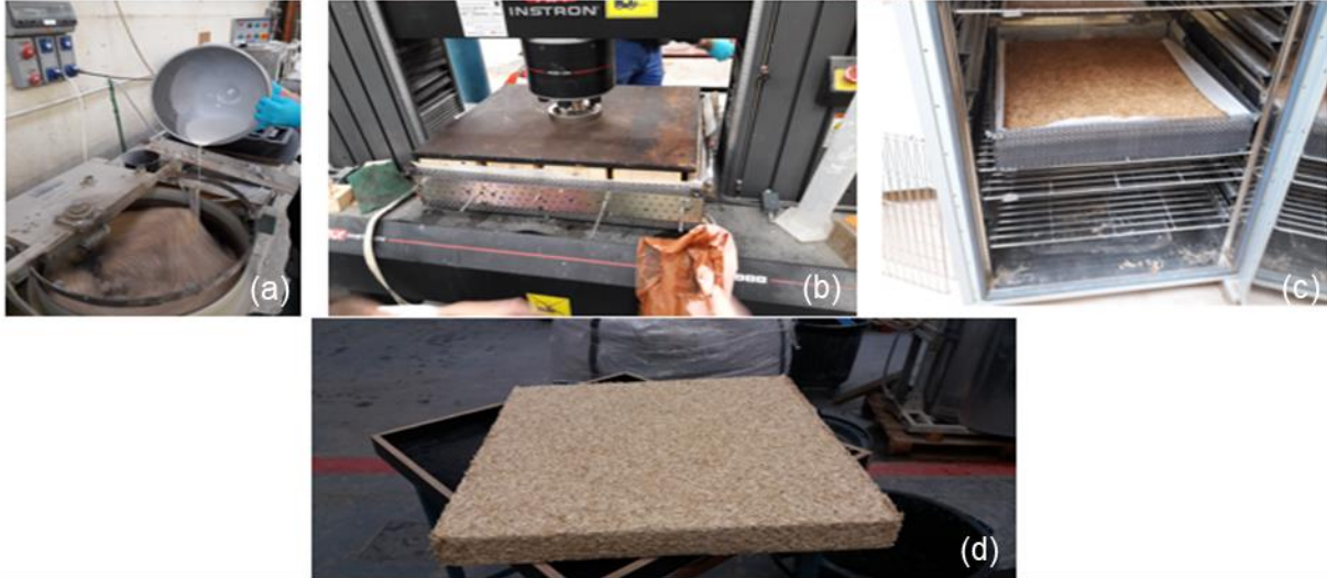
Figure II-14 : Production des panneaux PVA-Chanvre – (a) Mélange PVA – chanvre, (b) compactage, (c) étuvage, (d) panneau démoulé
