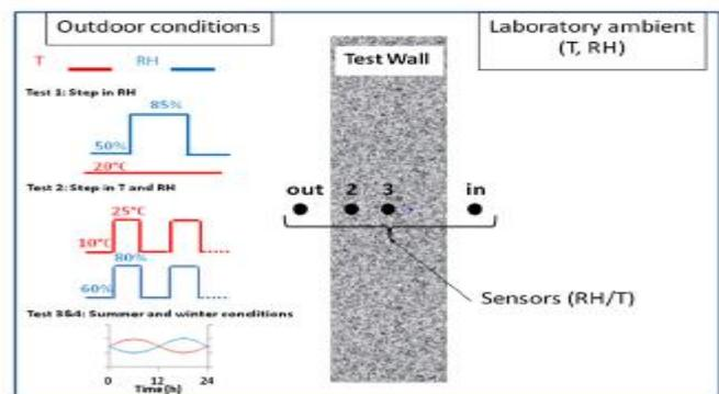
Figure I-18 : Protocoles d'essai et localisation des capteurs
