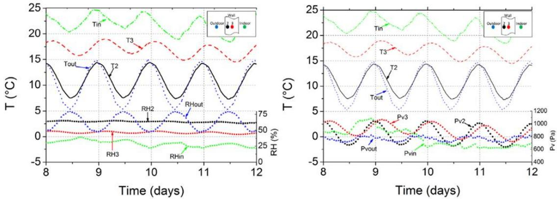
Figure I-19 : Evolution de la température et de l'humidité au sein des murs (gauche : béton de chanvre, droite : béton de colza)
