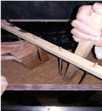
Figure II-23 : capteurs placés dans le terre-chanvre
