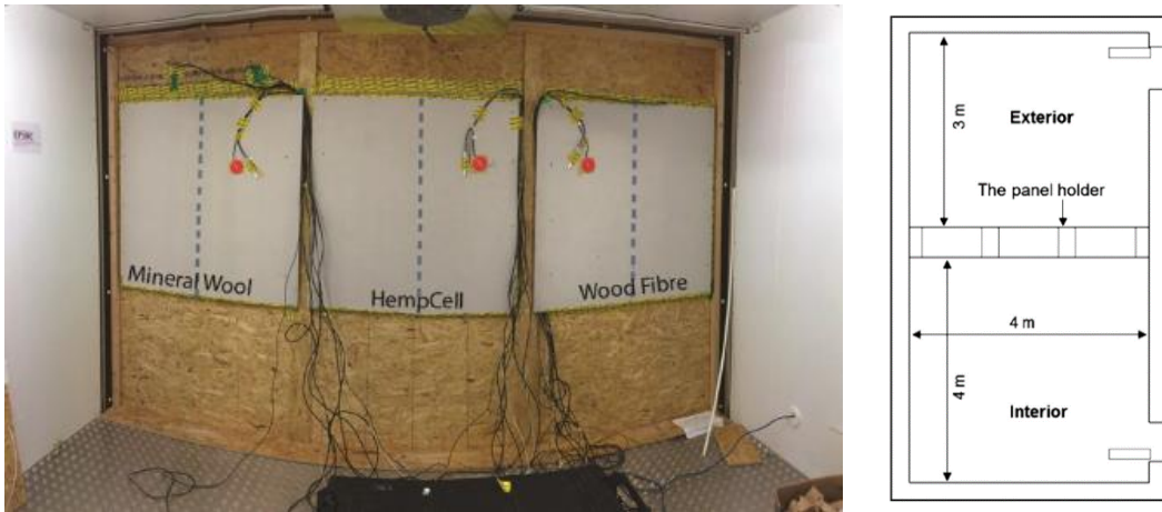
Figure I-28 : Mur test de (Latif et al. 2018)
