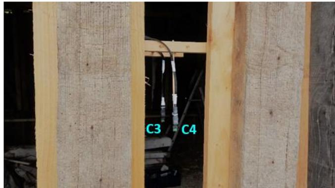
Figure IV-4 : Implantation des capteurs au sein du béton de chanvre en paroi sud
