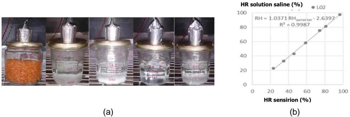
Figure II-21 : Vérification des capteurs - (a) solutions salines, (b) courbes d'ajustement
