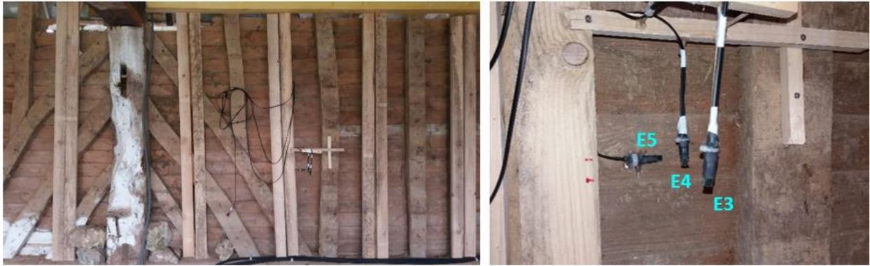
Figure IV-8 : Implantation des capteurs au sein du béton de chanvre en paroi nord
