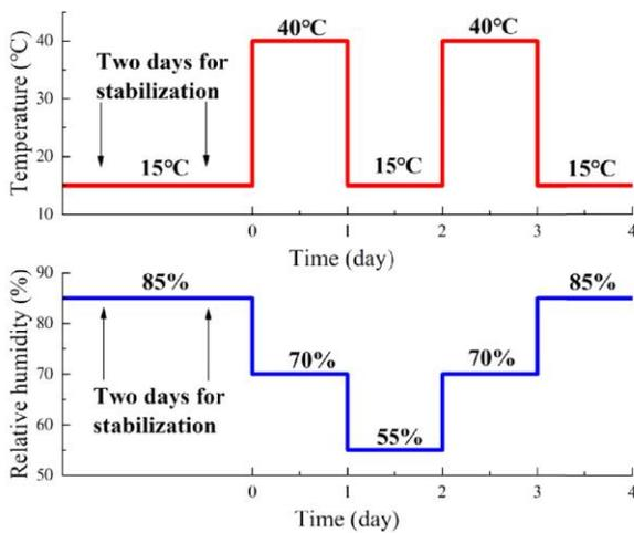
Figure I-20 : Sollicitations cycliques imposées côté chambre climatique
