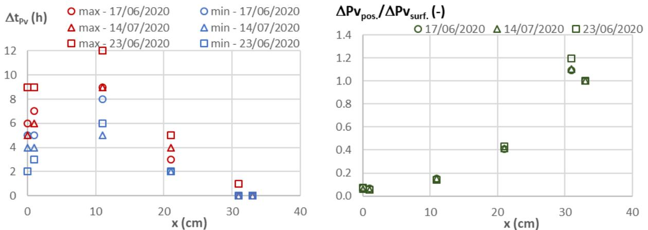
Figure IV-32 : Déphasage et amplitude relative à l'amplitude en surface extérieure de la pression de vapeur sur l'épaisseur de la paroi sud en période représentative (17/06/2020), nuageuse (14/07/2020) et chaude ensoleillée (23/06/2020)
