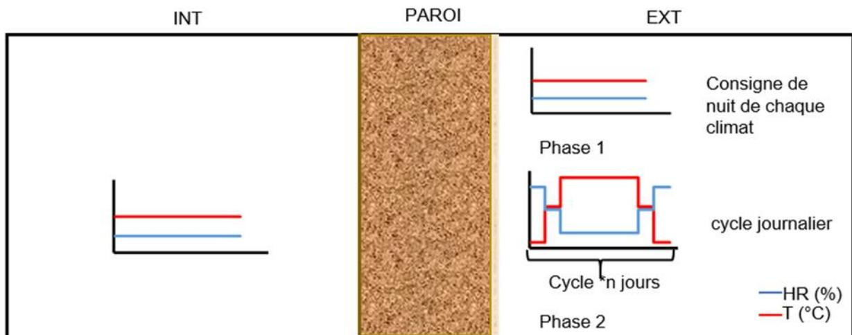
Figure II-39 : Points de consigne intérieurs et extérieurs pendant le test
