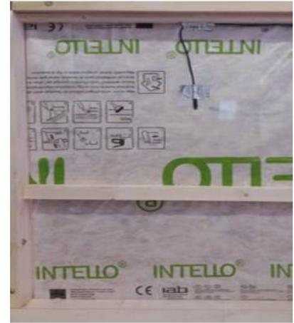
Figure II-25 : capteurs placés de chaque côté de la membrane
