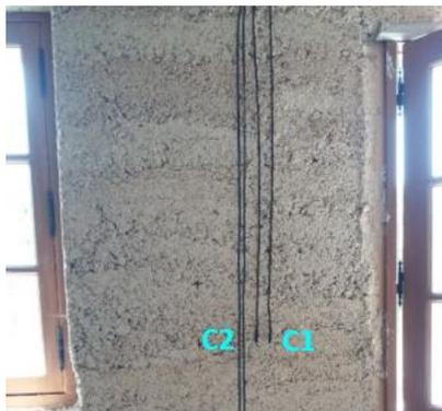
Figure IV-5 : Implantation des capteurs à l'interface béton de chanvre-enduit intérieur et en surface intérieure (en attente) en paroi sud
